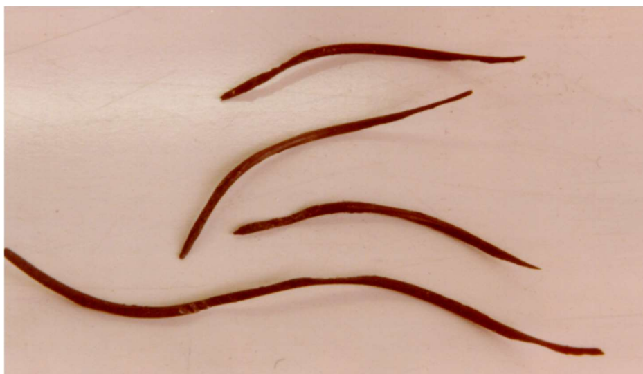
図5 摩耗で脱落したストランド最外層素線
