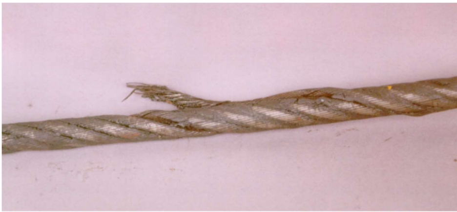
(b) 破断端から 245 mm
