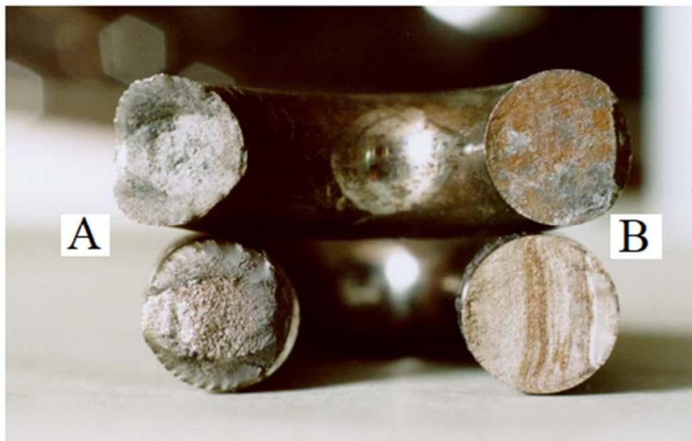
図5 チェーンリンクの破断状態（上下が対になっており，左がA部，
