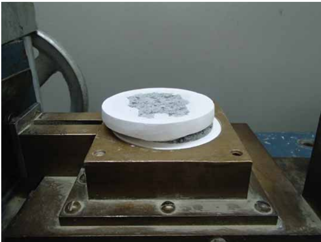
写真-3.5 上下の円盤供試体がせん断された時の様子
