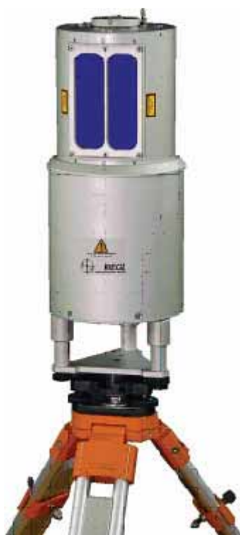
写真-2.1 3D スキャナ/プロファイルシステム LMS-Z210 (RIEGL 社製)
