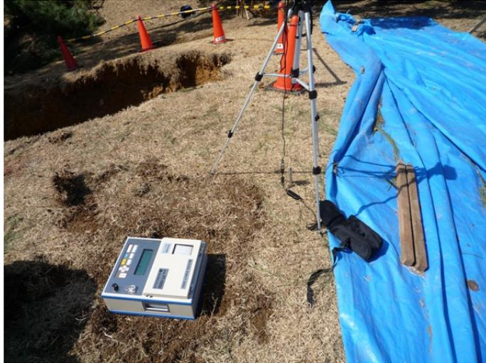
写真-2.4 RI計器による土の密度測定
