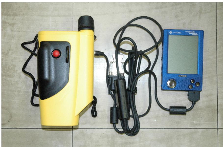
写真-2.1 ノンプリズム測距儀による地形測量システム装置構成
