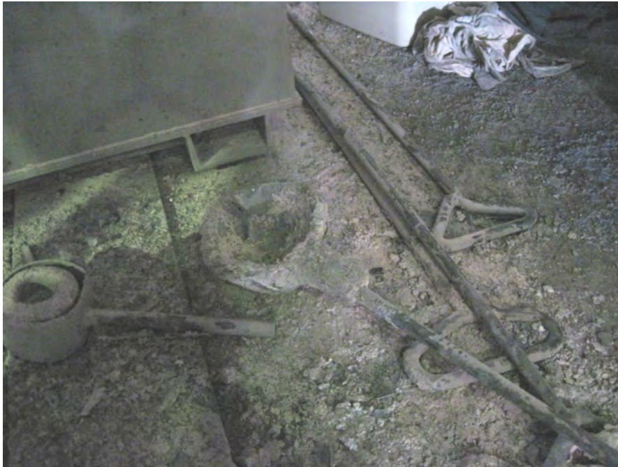
写真1 溶湯の飛散状況（上：俯瞰、下：炉近傍）
