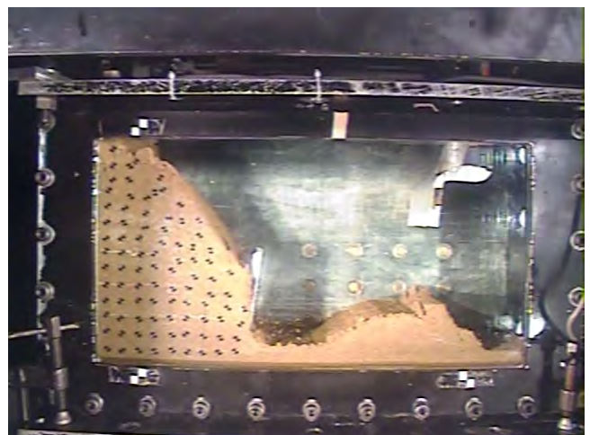
②崩壊した土砂は鋼矢板により抑制
