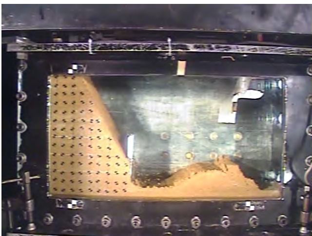
①掘削底盤から若干の滑りが発生
