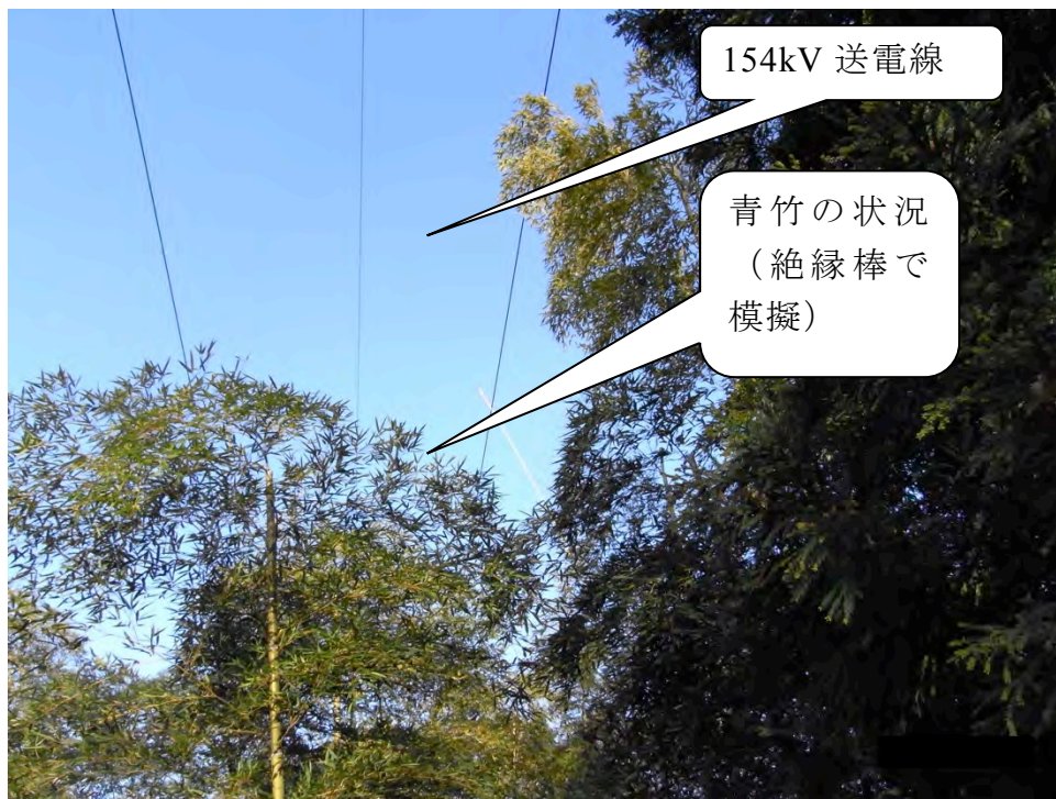
写真1 送電線と青竹(模擬)の状況
