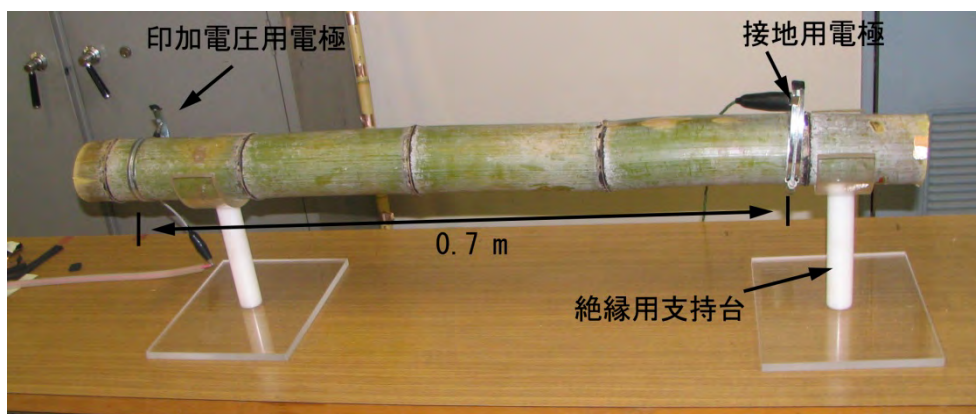
写真7 抵抗測定時の青竹の設置状況
