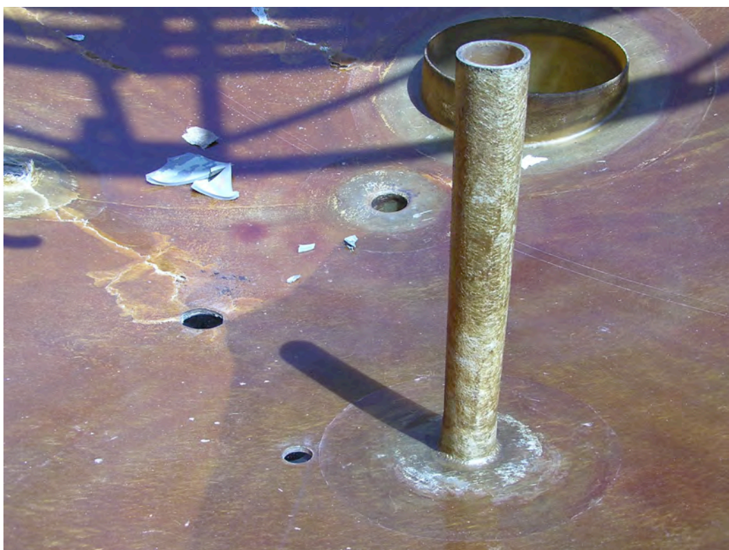
図 8: 爆破したタンクの内面 2
