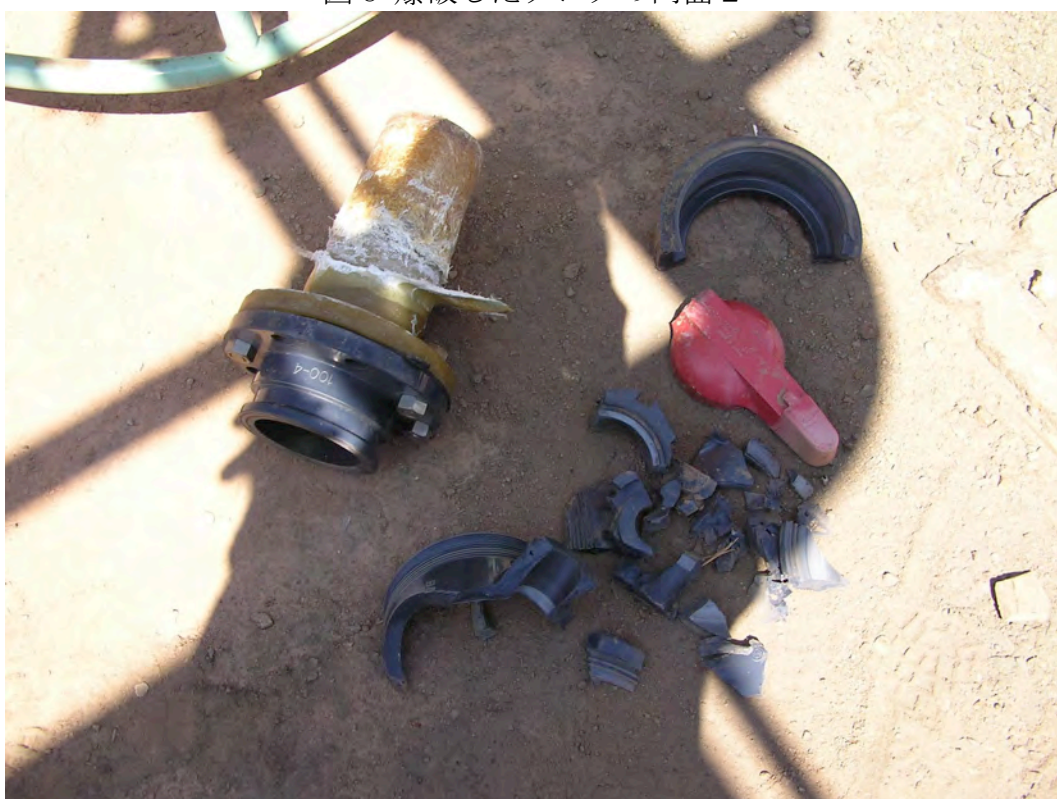
図 9: 破損した脱臭ボールバルブ
