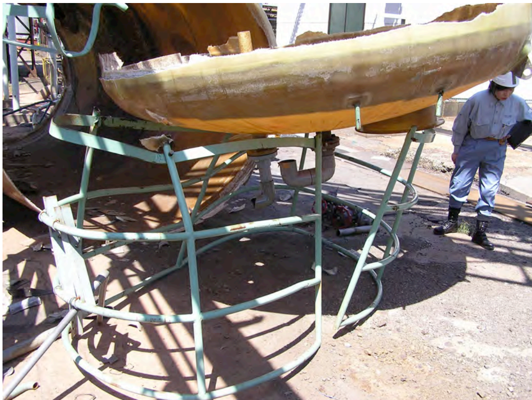
図 3:爆発により飛ばされたタンク
