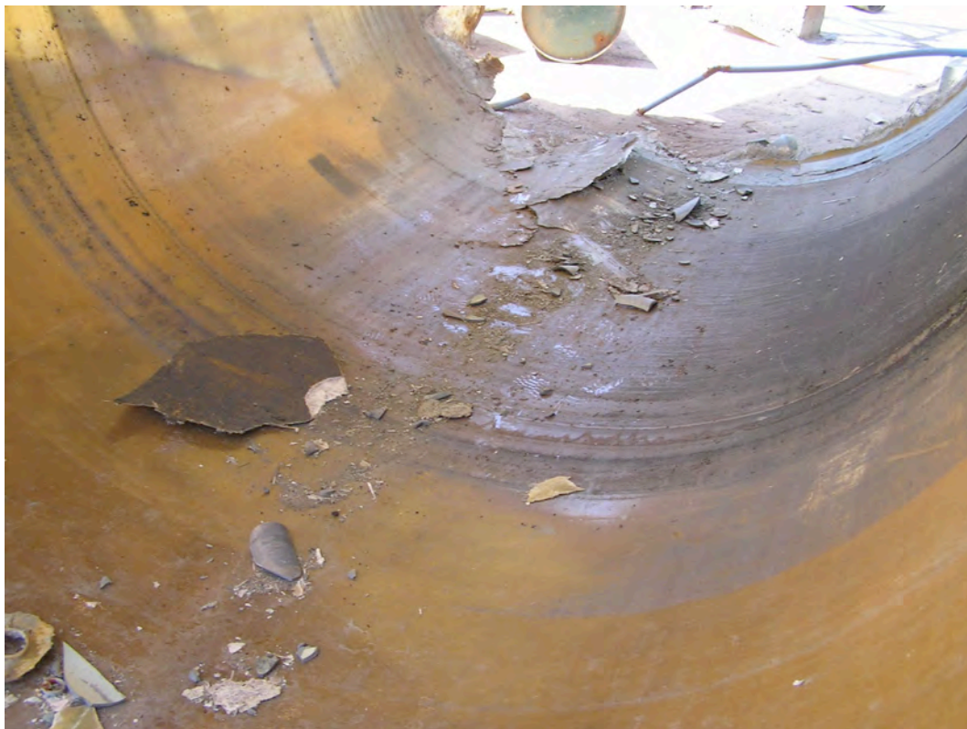
図 7: 爆破したタンクの内面 1
