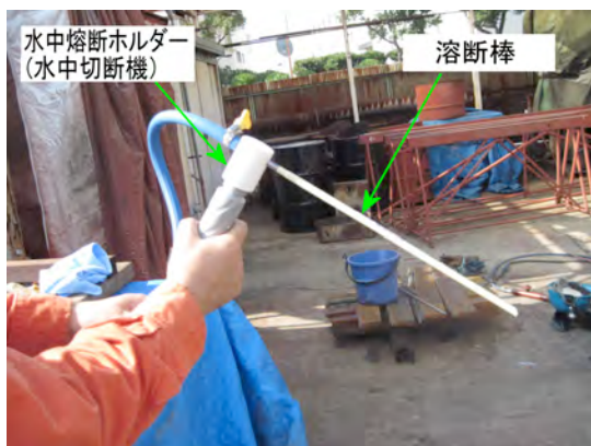
写真 5-1 水中切断機と溶断棒
