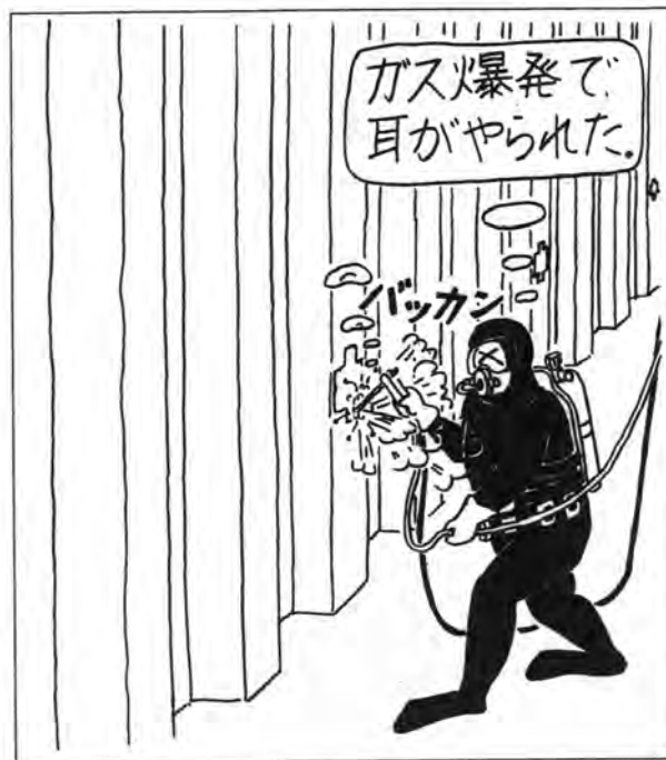
図 7-2 水中溶接・切断作業時の危険性：ガス爆発 2)
