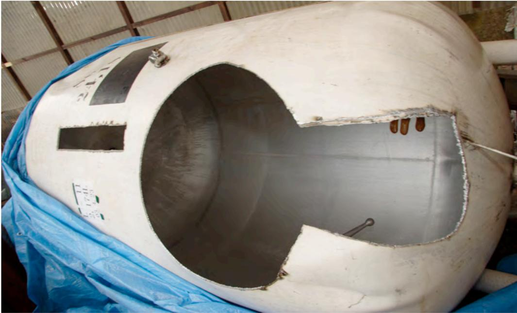
写真 1:破損したタンク
