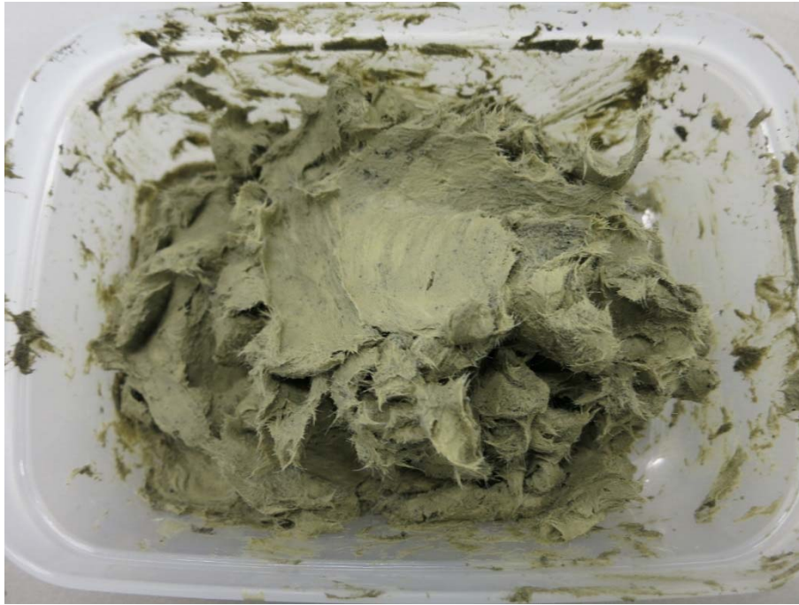
(b) 裏込め注入材 20%と止水材 B 80%の混合物 図 2.3 裏込め注入材と止水材 B の混合物
