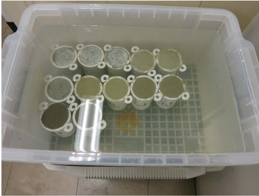
図 2.5 供試体を海水中に養生している様子
