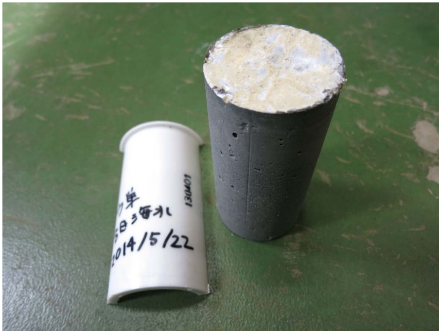
図 2.6 プラスチック製のモールドから供試体を脱型
