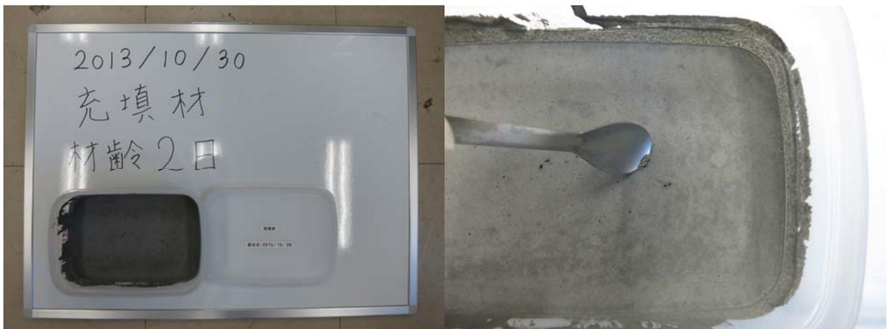
図 9.2.9 横坑の充填材（材齢 2 日）
