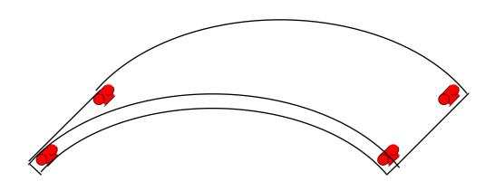
図 8.4.1 A1 セグメントのコンクリート部分から円柱供試体を採取。
