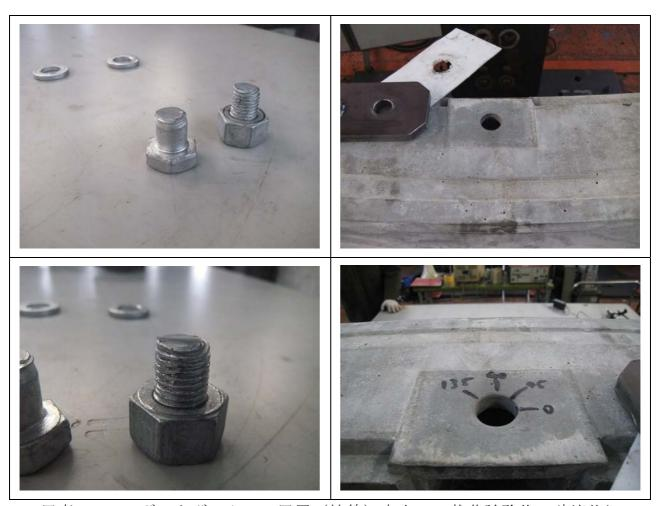
写真 8.3.14 ボルトボックスの円周 (接線) 方向への載荷試験後の破壊状況
