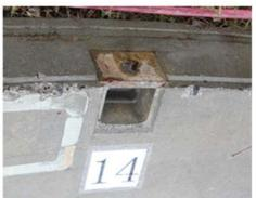
ボルトインサート部のコーン破壊とボルトの破断の両方が発生する方向に力がかかったと考えられる。
