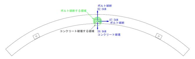
(b) ボルトが破断する領域とコンクリート破壊する領域
