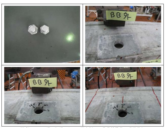
写真 8.3.12 ボルトボックスの地山側への載荷試験後の破壊状況
