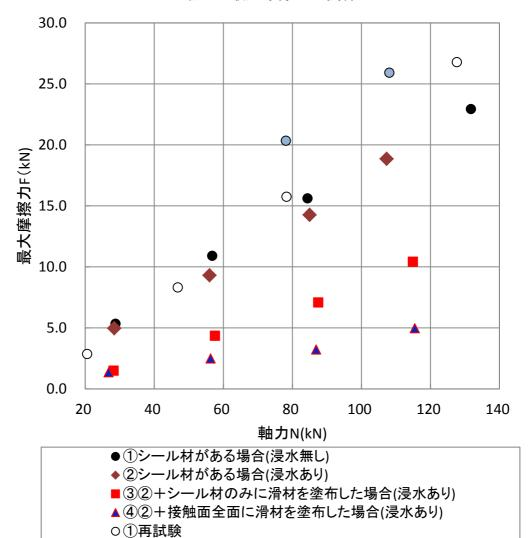
図 8.5.10 最大摩擦力と軸力の関係
