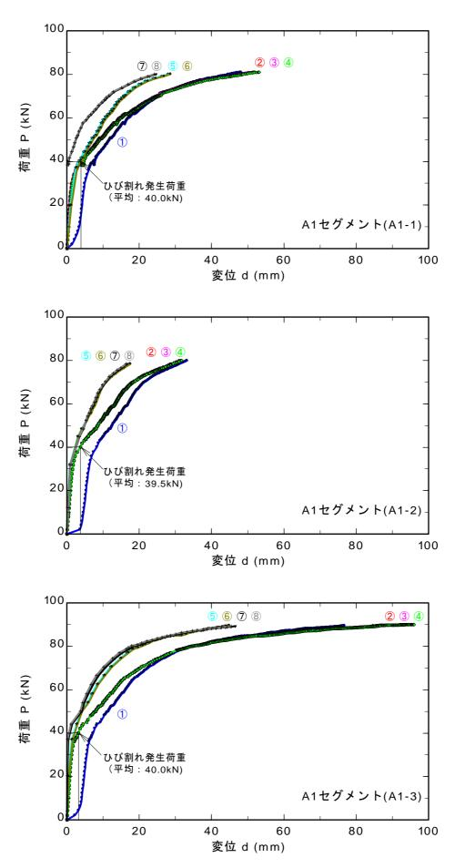
図 8.2.3 A1 セグメントの単体曲げ試験時の荷重と変位の関係
