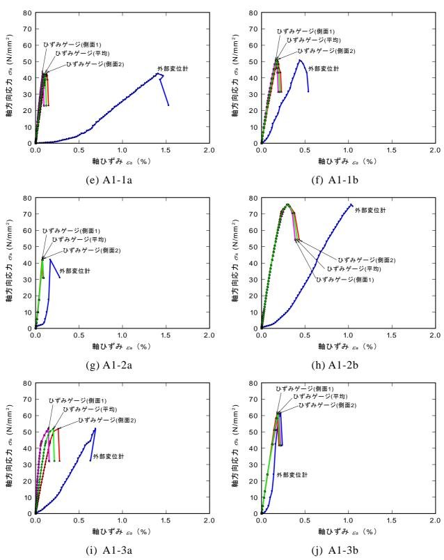
図 8.4.2 一軸圧縮試験時の応力ひずみ関係
