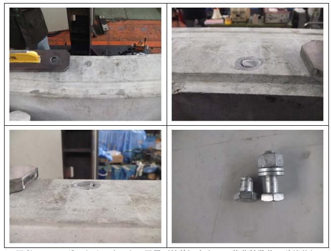
写真 8.3.13 ボルトインサートの円周 (接線) 方向への載荷試験後の破壊状況
