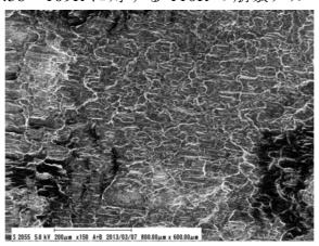
図 8.1.39 後述するリング継手の載荷試験(接線方向)により破断されたボルトの破断面(レプリカ)の観察結果(一方向に伸長したディンプルであることが見て取れる。)
