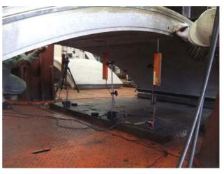
(b) 載荷盤直下のセグメントの変位計測
