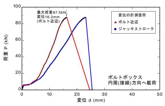
図 8.3.19 ボルトボックスの円周 (接線) 方向への載荷試験結果
