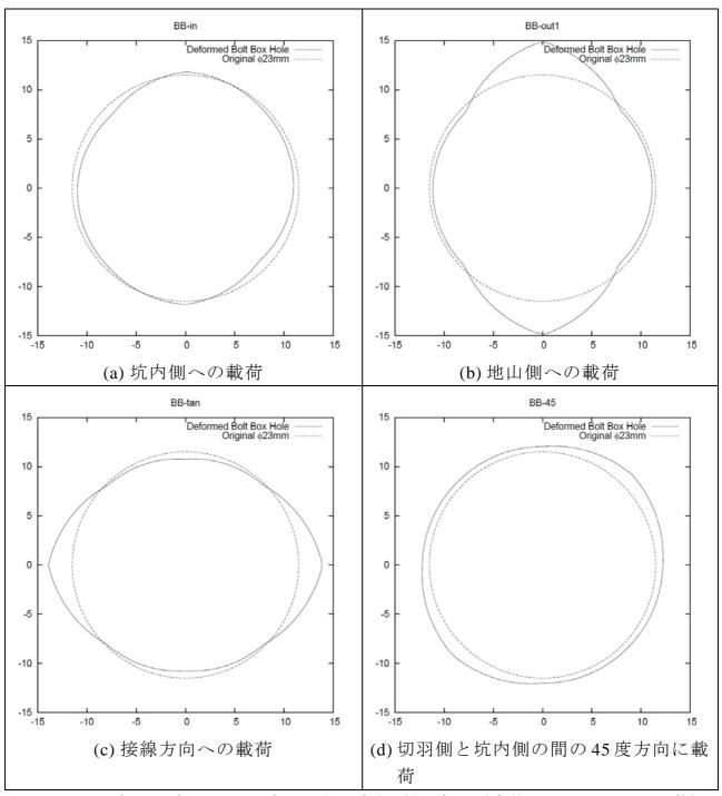
図 8.3.28 ボルトボックスのボルト穴の内径計測結果 (変位を 10 倍にして記載)
