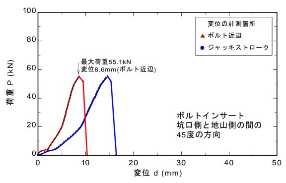
図 8.3.21 ボルトインサートを坑口側と地山側の間の 45 度の方向へ載荷した試験結果
