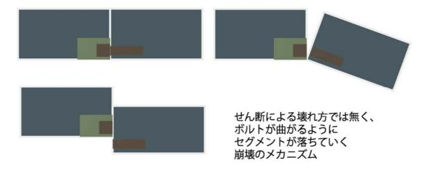
図 8.1.38 109R に対する 110R の崩壊メカニズム
