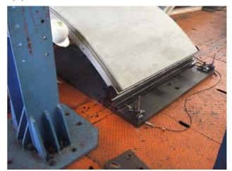
(d) セグメント端部の変位計測 写真 8.2.1 セグメント単体曲げ試験の試験状況
