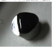
(b) レプリカ採取中 図 8.1.36 ボルト破断面のレプリカ採取用の道具
