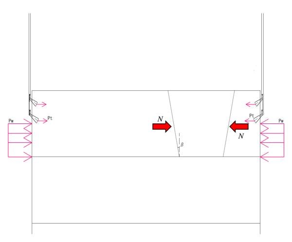
図 8.6.1 K セグメントに加わる軸力(作用水圧 Pw, テールブラシ圧 Pt, 合力(軸力)N)
