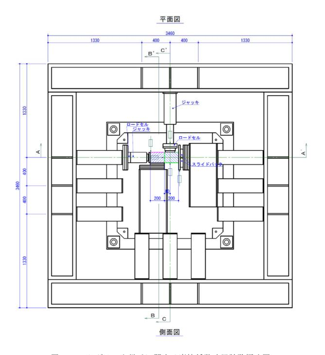
図 8.5.2 セグメント継手に関する摩擦係数確認試験概略図
