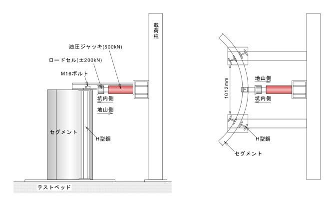
図 8.3.7 ボルトインサート及びボルトボックスの坑内側及び地山側への載荷方法の 概略図
