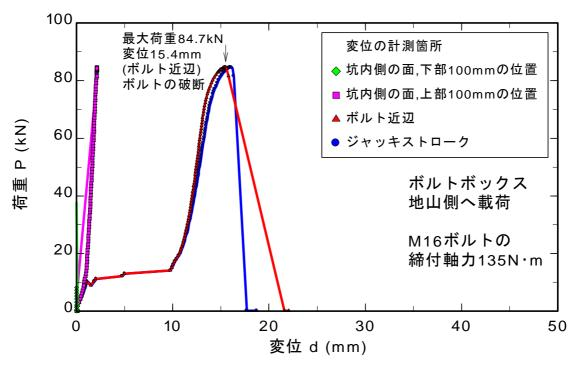
図 8.3.16 ボルトボックスの地山側への載荷試験結果 (M16 ボルトの締付軸力 135N·m)
