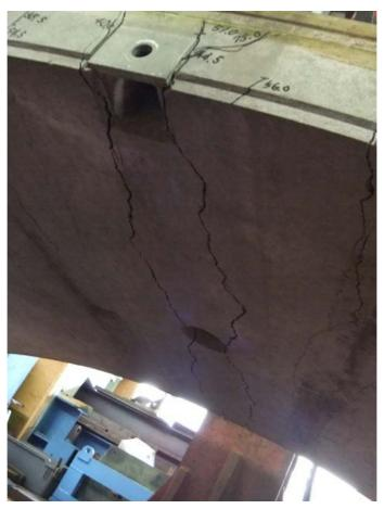
写真 8.2.6 A1-3 の単体曲げ試験後のひび割れ発生状況 (セグメント中央坑内側)
