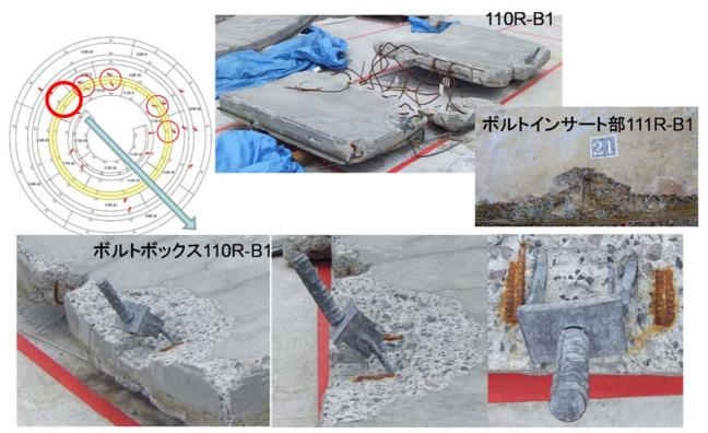
ボルトボックスにはく離の方向に力がかかっている。変形が大きいのは徐々に変形が進んだためと考えられる。
