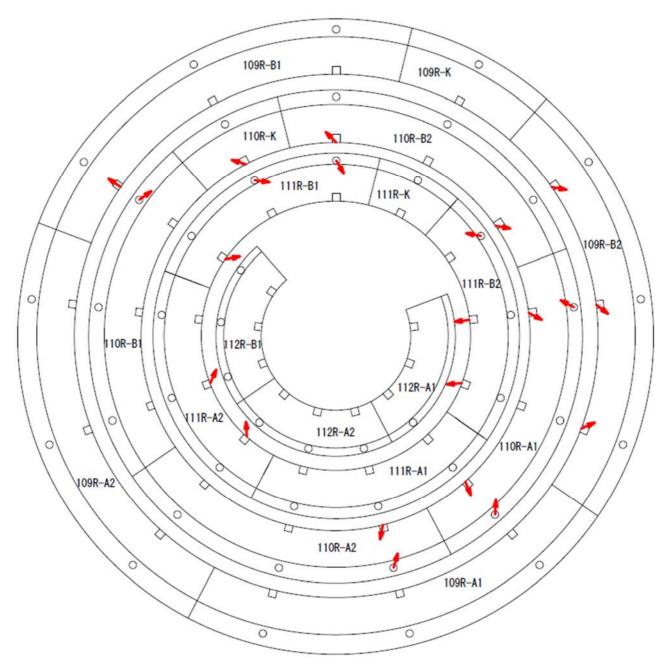
図 8.1.19 ボルトボックスのボルト穴とボルトインサートに残存したボルトの変形の方向(矢印の方向は、矢印が位置しているセグメントの動きとして記載。)
