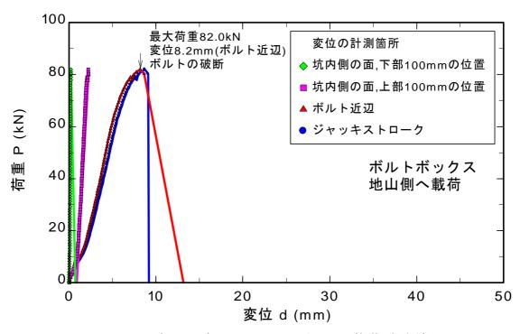
図 8.3.15 ボルトボックスの地山側への載荷試験結果
