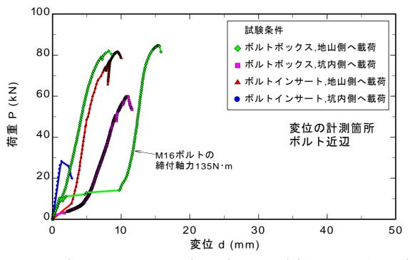
図 8.3.17 ボルトインサート及びボルトボックスの坑内側及び地山側への載荷試験 結果
