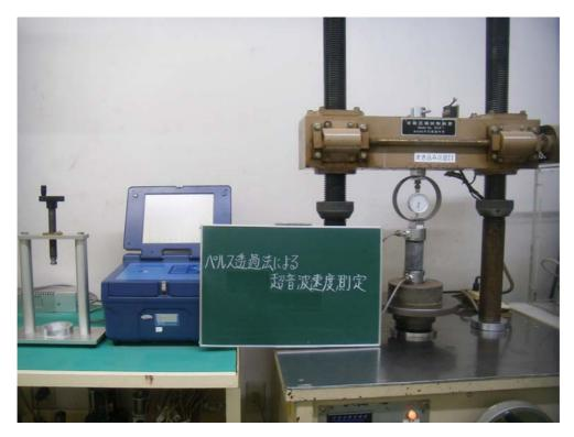
写真 8.4.3 超音波速度測定状況例
