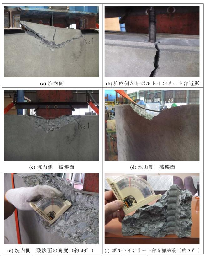
写真 8.3.2 ボルトインサートの引抜き試験後の写真 (A2-No.1)
