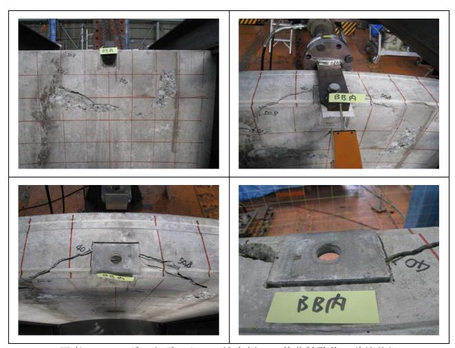
写真 8.3.11 ボルトボックスの坑内側への載荷試験後の破壊状況
