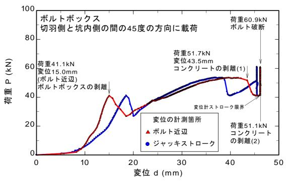
図 8.3.22 ボルトボックスを切羽側と坑内側の間の 45 度の方向へ載荷した試験結果
