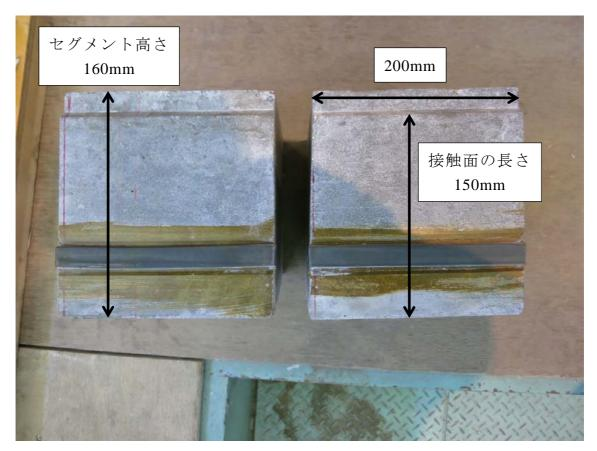
図 8.5.3 K セグメントと B1 セグメントのセグメント継手面の一部を切り出した部分供試体 (接触面の長さ 150mm×200mm)
