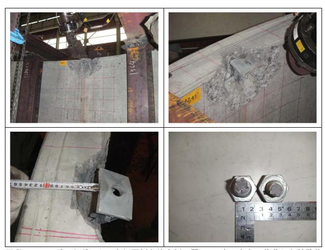
写真 8.3.16 ボルトボックスを切羽側と坑内側の間の 45 度の方向へ載荷した試験後の破壊状況
