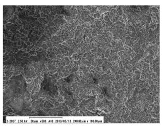
(a) 110R の B2 のボルト破断面 (No.31) (b) 110R の A1 のボルト破断面 (No.28) 図 8.1.37 電子顕微鏡による当該セグメントのボルト破断面 (レプリカ) の観察結果
