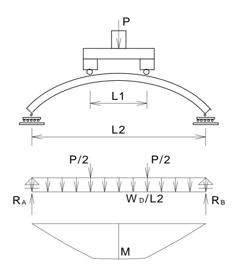
図 8.2.5 セグメント単体曲げ試験時の曲げモーメントの算出方法
