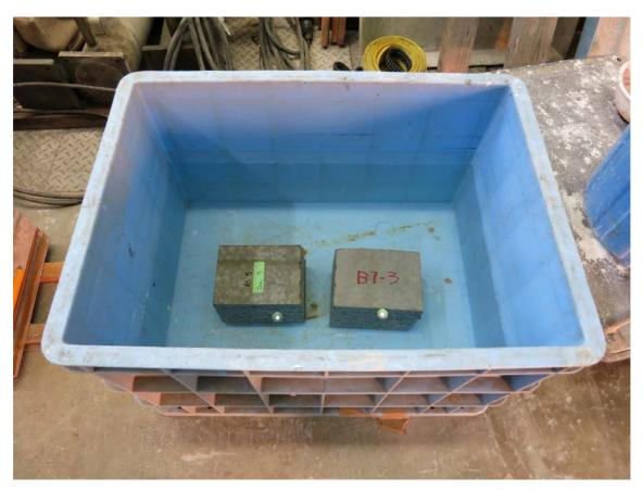
図 8.5.4 部分供試体を水浸させている状態(試験 No.②,③,④)
