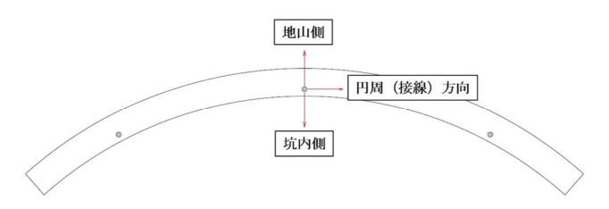
図 8.3.6 ボルトインサートに関する載荷試験の方向
