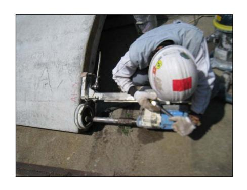
写真 8.4.1 A1 セグメントのコンクリート部分から円柱供試体を採取
