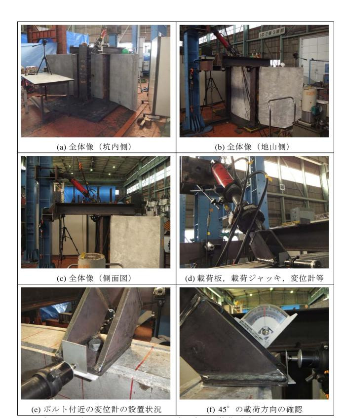
写真 8.3.7 坑口側と地山側の間の 45 度の方向に載荷 (ボルトインサート)
