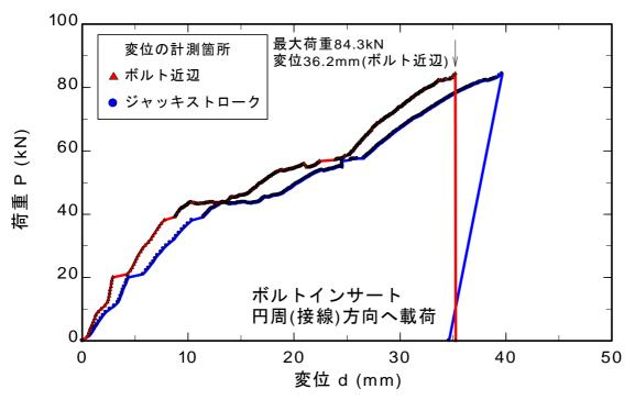
図 8.3.18 ボルトインサートの円周 (接線) 方向への載荷試験結果
