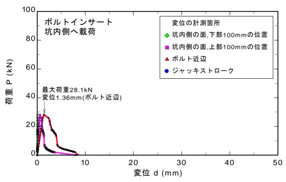
図 8.3.12 ボルトインサートの坑内側への載荷試験結果
