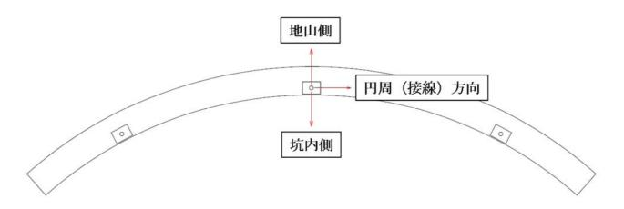
図 8.3.5 ボルトボックスに関する載荷試験の方向
