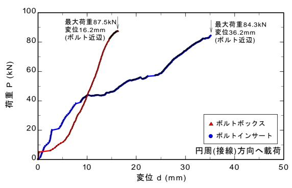
図 8.3.20 ボルトインサート及びボルトボックスの円周(接線)方向への載荷試験結果
