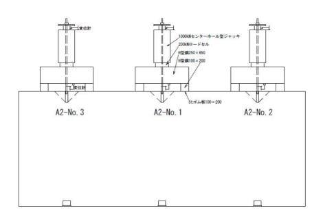
図 8.3.1 A2 セグメントに対するボルトインサートの引抜き試験
