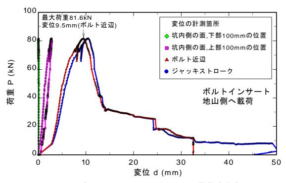
図 8.3.13 ボルトインサートの地山側への載荷試験結果
