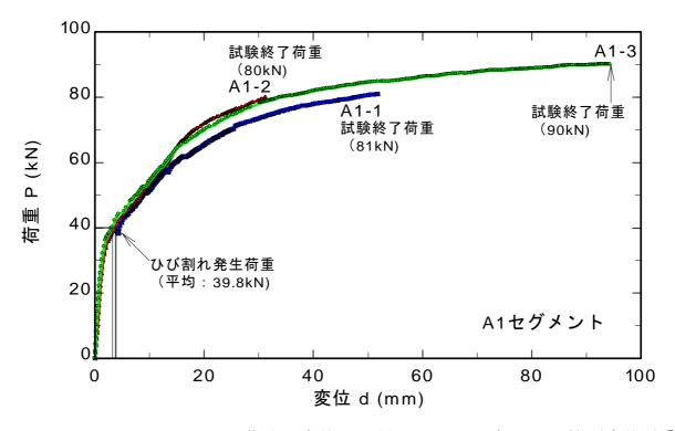
図 8.2.4 A1-1, A1-2, A1-3 の荷重と変位の関係を同じ図面内にて比較(変位計③)
