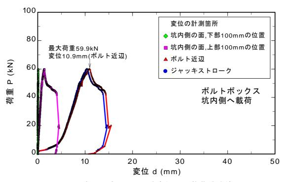
図 8.3.14 ボルトボックスの坑内側への載荷試験結果
