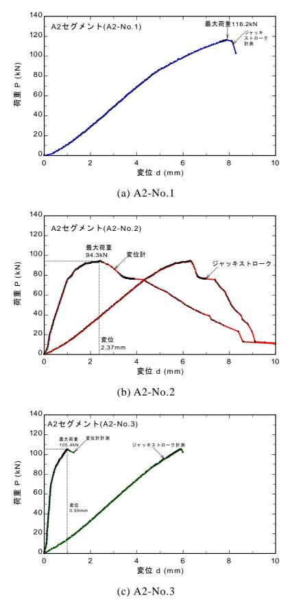
図 8.3.2 ボルトインサートの引抜き試験時の荷重と変位の関係
