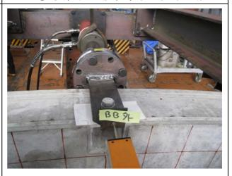
⑥ 変位計の設置状況(載荷板)
