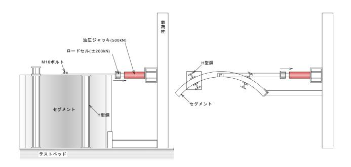
図 8.3.9 円周 (接線) 方向への載荷方法の概略図
