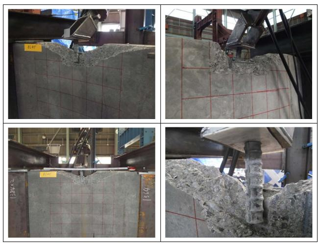
写真 8.3.15 ボルトインサートを坑口側と地山側の間の 45 度の方向へ載荷した試験 後の破壊状況
