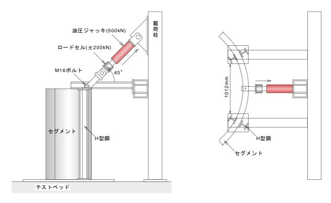
図 8.3.10 坑口側と地山側の間の 45 度の方向に載荷 (ボルトインサート)
