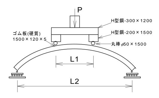
図 8.2.1 セグメント単体曲げ試験の試験方法
