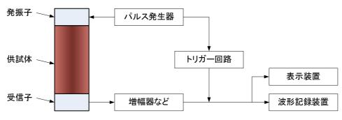
図 8.4.4 超音波速度測定装置の構成例
