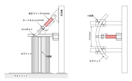
図 8.3.11 切羽側と坑内側の間の 45 度の方向に載荷 (ボルトボックス)
