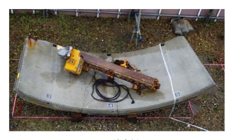
(c) 坑内側 図 8.1.15 112R の B2 セグメントの破損状況
