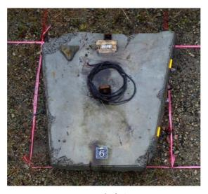
(c) 坑内側 図 8.1.16 112R の K セグメントの破損状況
