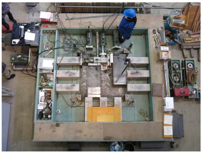
図 8.5.1 二次載荷試験装置((独)土木研究所 構造力学実験施設内)
