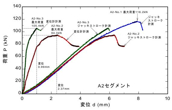
図 8.3.3 ボルトインサートの引抜き試験時の荷重と変位の関係(各試験結果の比較)
