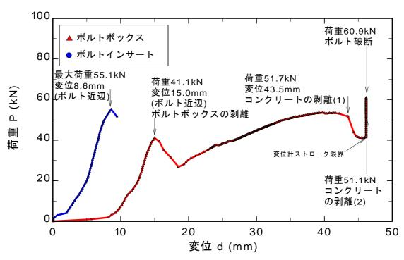
図 8.3.23 ボルトインサートを坑口側と地山側の間の 45 度の方向へ載荷した試験及びボルトボックスを切羽側と坑内側の間の 45 度の方向へ載荷した試験結果
