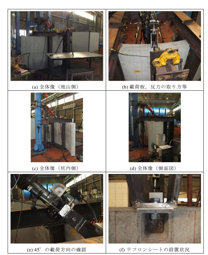
写真 8.3.8 切羽側と坑内側の間の 45 度の方向に載荷 (ボルトボックス)
