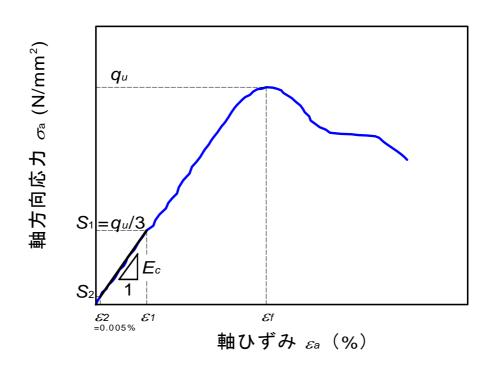
図 8.4.3 静弾性係数  $E_c$  および一軸圧縮強さ  $q_u$  の求め方
