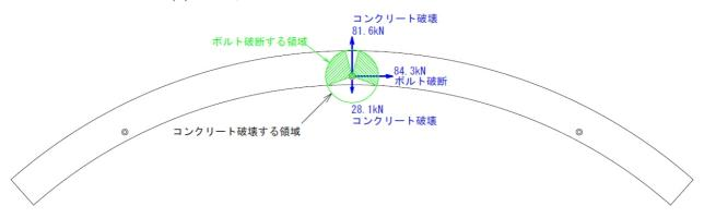
(b) ボルトが破断する領域とコンクリート破壊する領域
