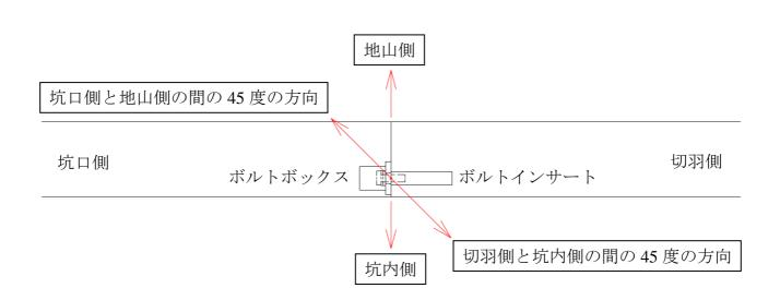
図 8.3.4 ボルトインサート及びボルトボックスに関する載荷試験の方向
