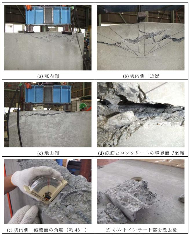
写真 8.3.3 ボルトインサートの引抜き試験後の写真 (A2-No.2)
