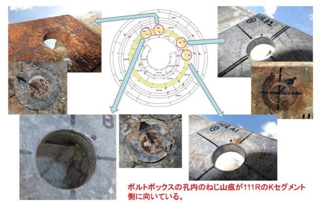
図 8.1.20 111R の B1 及び B2 のボルトインサートに残存したボルトの変形と 110R の A1, B2 及び K のボルトボックスのボルト痕の跡
