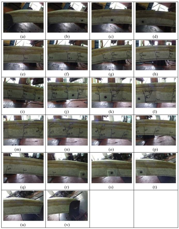
写真 8.2.2 A1 セグメント(A1-3)の単体曲げ試験後のひび割れ発生状況(切羽側, 左 → 右)
