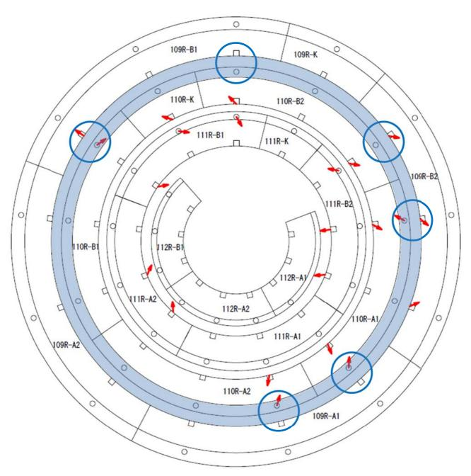
図 8.1.34 ボルトのせん断面を観察した箇所
