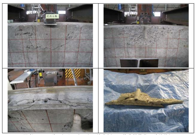
写真 8.3.9 ボルトインサートの坑内側への載荷試験後の破壊状況
