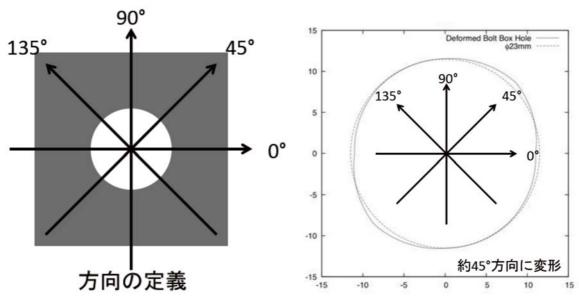
(b) ボルトボックスの内径を計測した箇所と方向の定義
