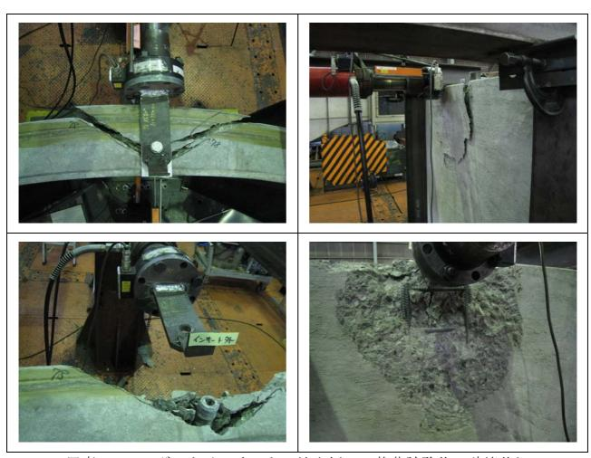
写真 8.3.10 ボルトインサートの地山側への載荷試験後の破壊状況
