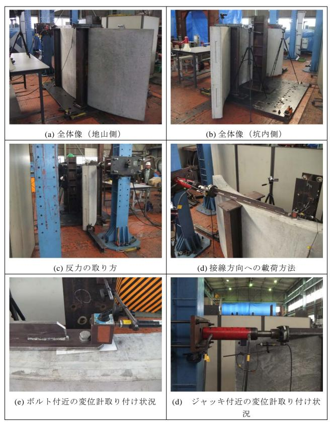
写真 8.3.6 ボルトインサート及びボルトボックスの坑内側及び地山側への載荷試験 状況
