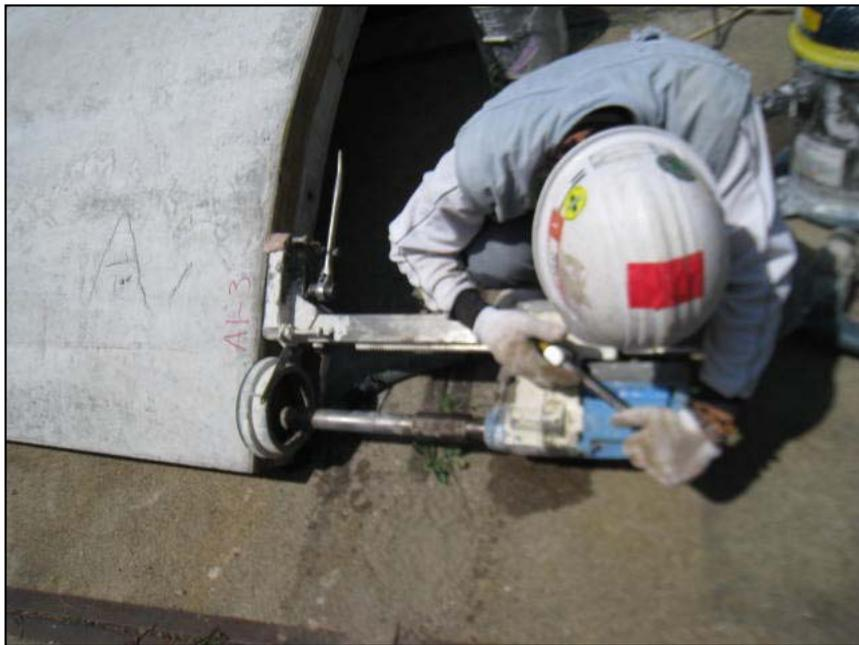
写真 8.4.1 A1 セグメントのコンクリート部分から円柱供試体を採取
