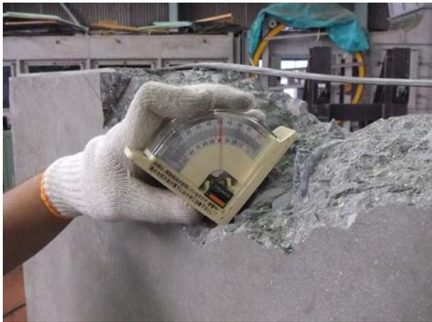
(e) 坑内側 破壊面の角度 (約 50°)
