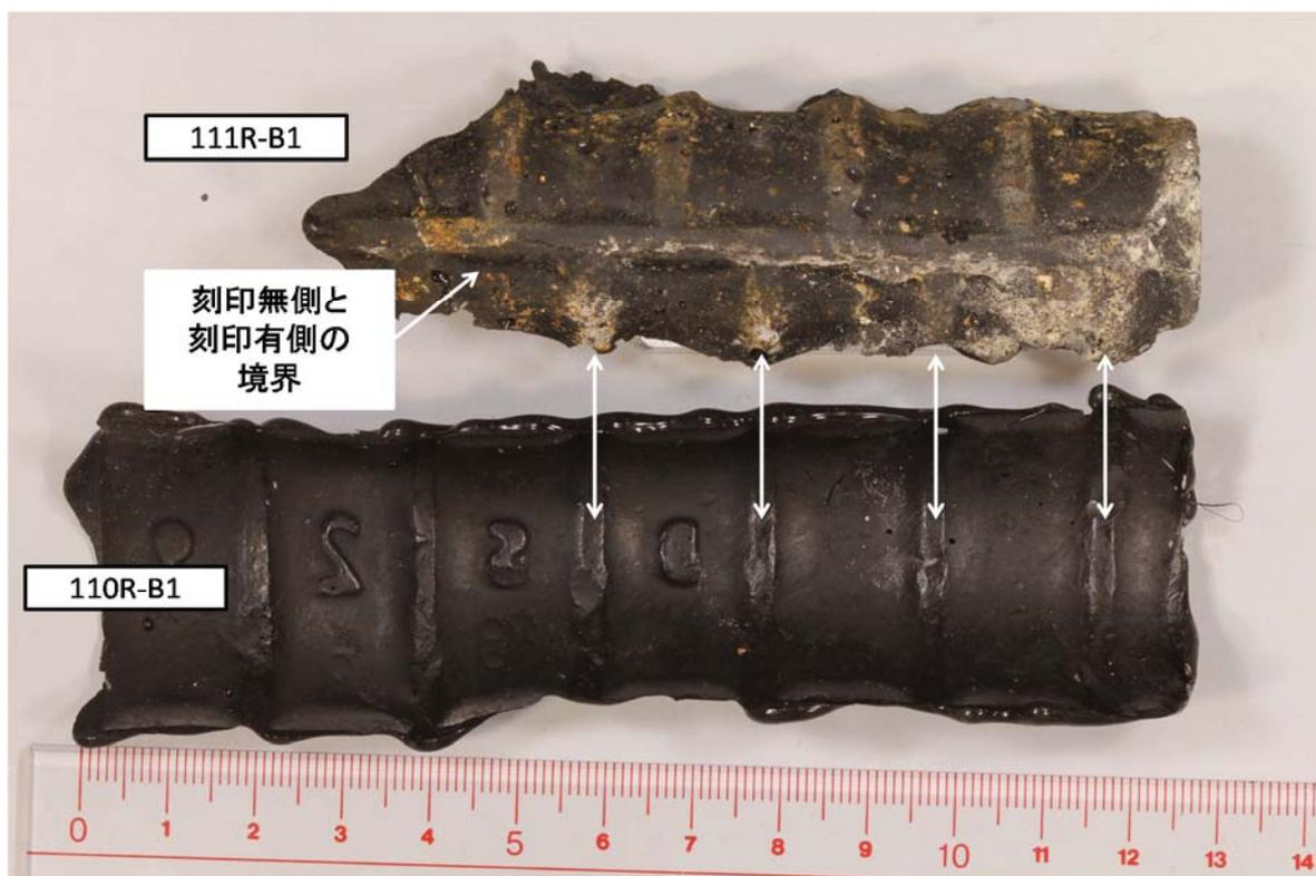
図 8.1.28 111R の B1 セグメントのボルトインサート部のレプリカと 110R の B1 のボルトボックスに引抜けた形で残存していた 111R の B1 セグメントのボルトインサートのレプリカ
