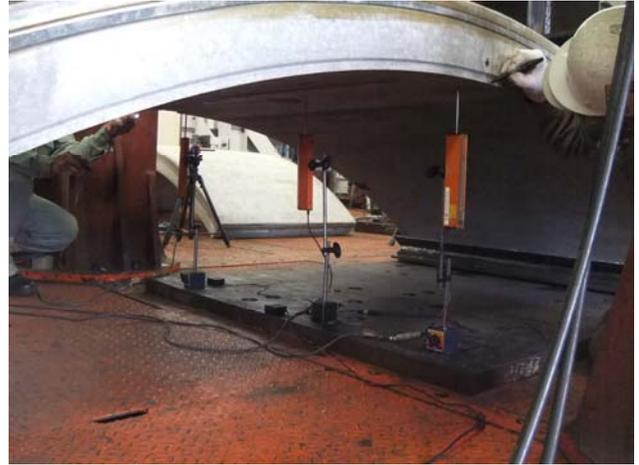
(b) 载荷盤直下のセグメントの変位計測
