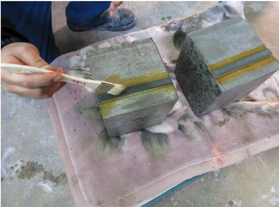
図 8.5.5 シール材のみに滑材を塗布している様子（試験 No.③）
