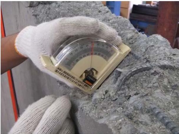
(e) 坑内側 破壊面の角度 (約 48°)
