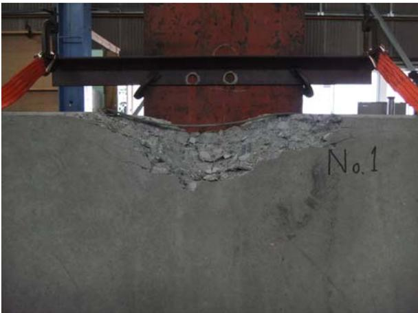
(c) 坑内側 破壊面
