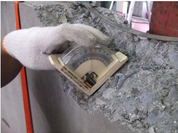
(e) 坑内側 破壊面の角度 (約  $43^{\circ}$ )
