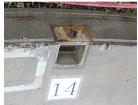
**ボルトインサート部のコーン破壊とボルトの破断の両方が発生する方向に力が加わったと考えられる。**
