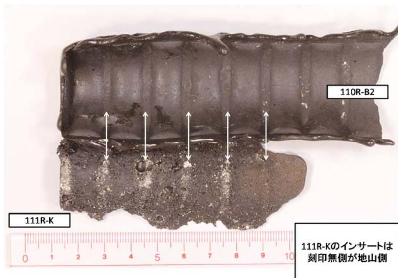
図 8.1.24 111R の K セグメントのボルトインサート部のレプリカと 110R の B2 のボルトボックスに引抜けた形で残存していた 111R の K セグメントのボルトインサートのレプリカ
