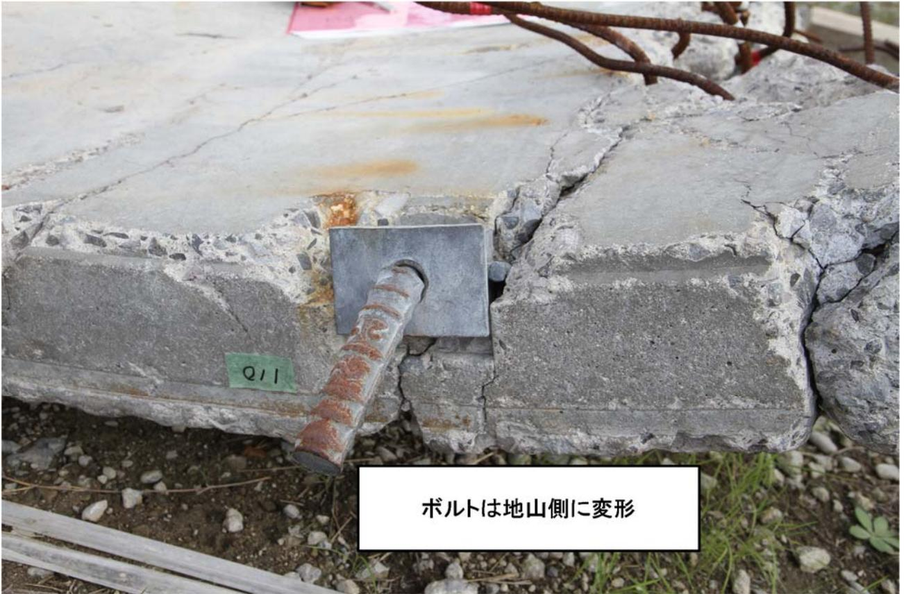
図 8.1.25 110R の B2 のボルトボックスに引抜けた形で残存していた 111R の K セグメントのボルトインサートの推定される災害発生直後の向き（ボルトは地山側に変形している。）
