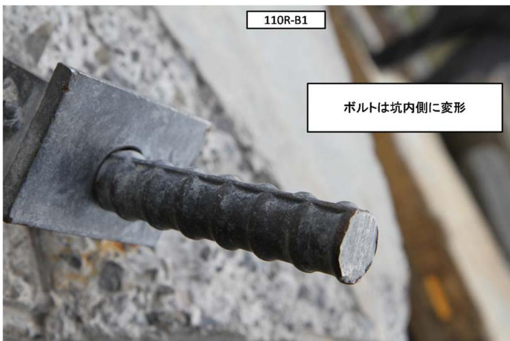
図 8.1.30 110R の B1 のボルトボックスに引抜けた形で残存していた 111R の B1 セグメントのボルトインサートの推定される災害発生直後の向き（ボルトは坑内側に変形している。）
