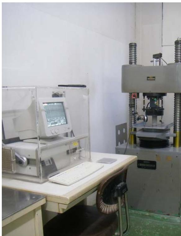
写真 8.4.2 一軸圧縮試験の様子
