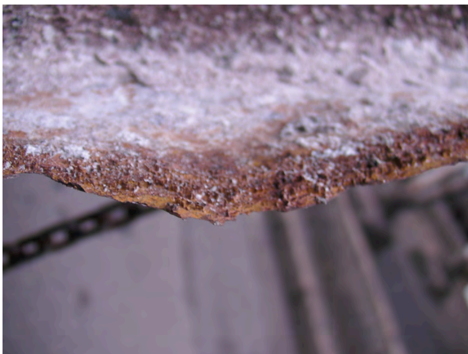
図8 明らかな減肉が見られる破断部分
