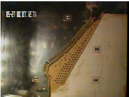
(7)(8)法先のはらみと, 土砂の沈下が同時に進行
