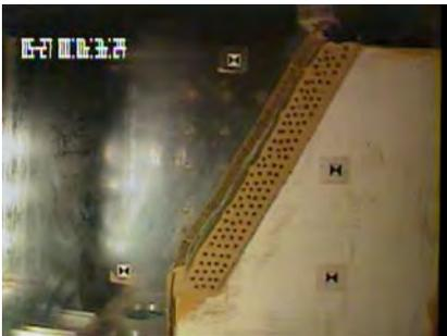
(4)(5)法先がはらみ, 同時に天端の土砂が沈下(11.4G)
