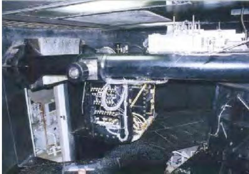
写真 4.2 遠心力载荷装置(NIIS Centrifuge)
