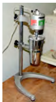
写真 1-5 セメントミルク攪拌機械と攪拌状況
