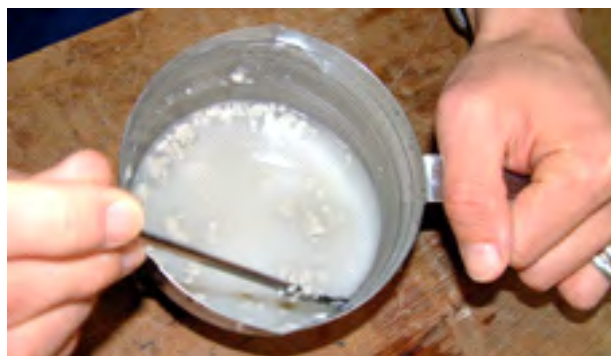
写真 1-3 ベントナイト泥水作成状況
