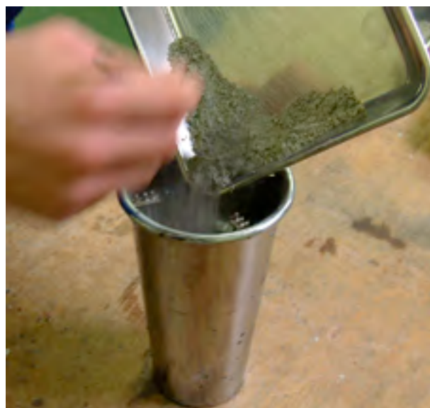
写真 1-4 ベントナイト泥水へのセメント添加状況
