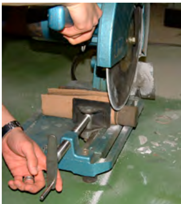
写真 1-10 供試体切断状況
