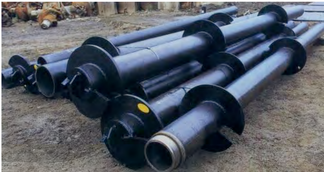
写真1 円形断面を有する鋼管杭の周囲に一定間隔でらせん状の羽根が取り付けられて、ソイルセメントやセメントミルクとの付着が高める対策が講じられた例
