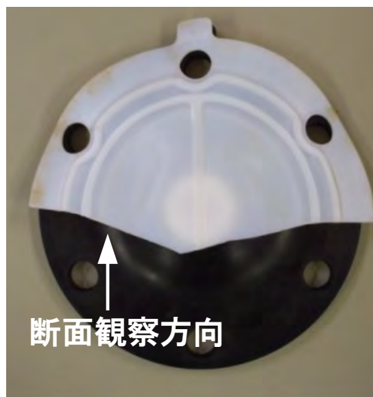
図4. 1 事故品の PTFE ガスケット
