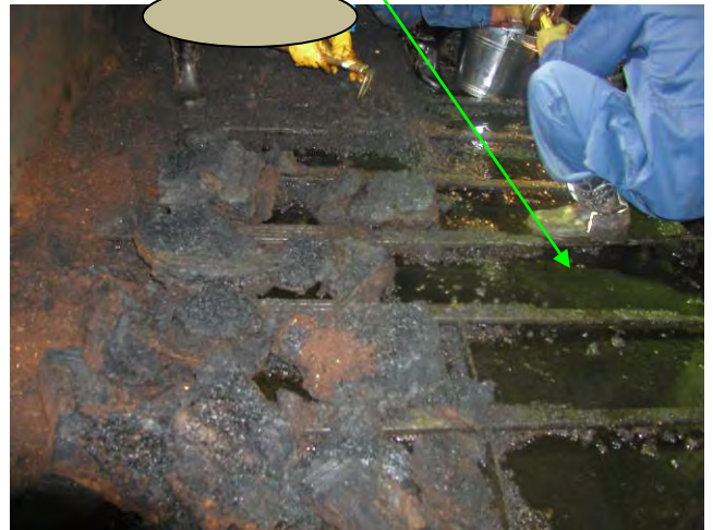
写真 6-33 生ごみ処理装置（発酵槽）内の堆積物（底部付近は黒く炭化している）
