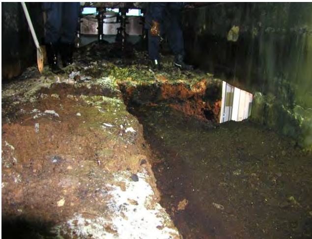
写真 6-32 生ごみ処理装置（発酵槽）内を掃除口側から見たところ（画面右半分はある深さまで既に掘り返されていた）
