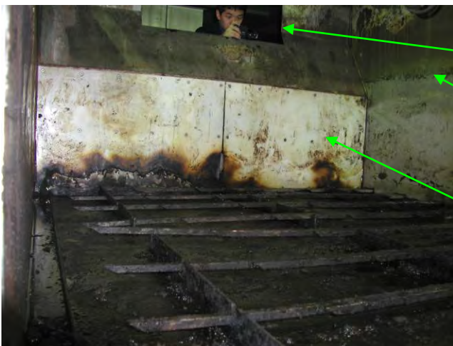
写真 6-36 生ごみ処理装置（発酵槽）内のプラスチック内壁の焼損状況（排出側と逆の方向を見たところ）
