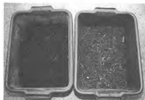
写真5 生ごみの炭化状況 (左：実験後、右：実験前)
