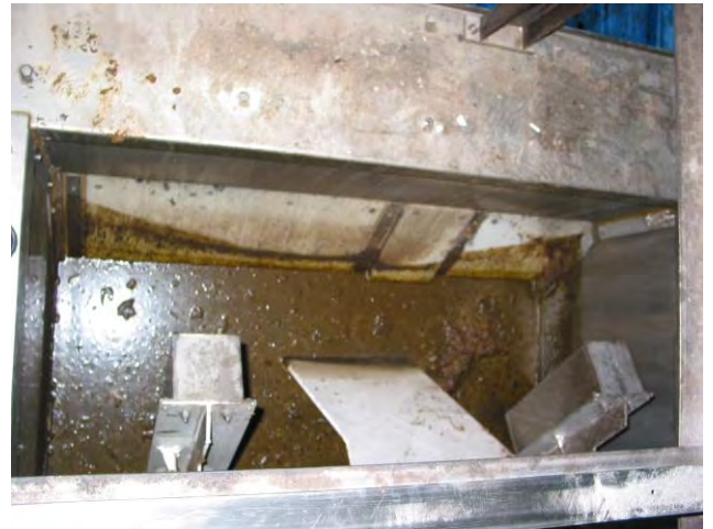
写真 6-44 乾燥槽を上から見たところ（消火水で水没している。写真では見えないが、下部にパドル翼が付いている）
