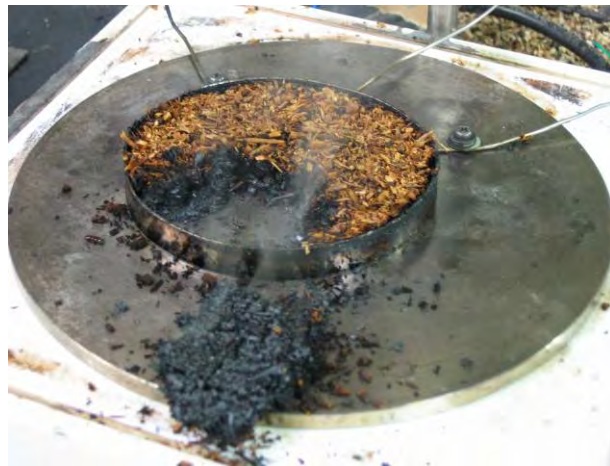
写真 8-4 パルミチン酸をおがくずに浸潤させた場合の内部の炭化の様子（斜め上方から撮影，設定熱面温度 280℃）
