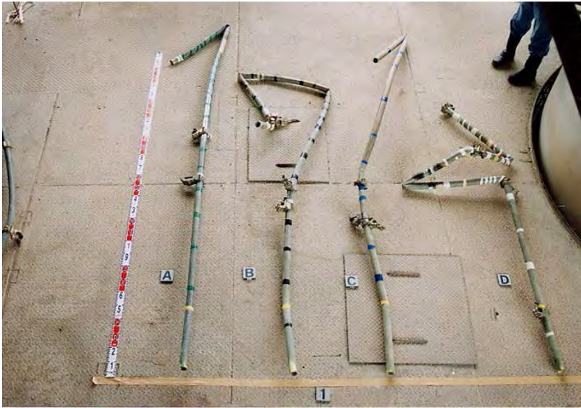
写真3 下から1本目の建地
