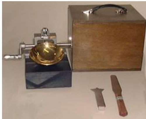
付図-2 液性限界試験器
