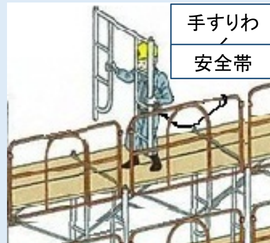
手すり先行工法
