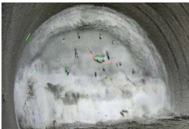
図-4.9 鏡クラック自動検知システム<sup>6)</sup>
