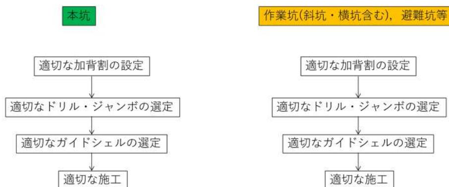
図-4.3 加背割及び掘削断面形状に対して適切にロックボルトを打設するためのフロー図
