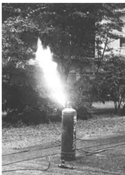
図 2.4 逆火によりアセチレン容器の可溶合金栓から噴出する炎（再現実験） 7)
