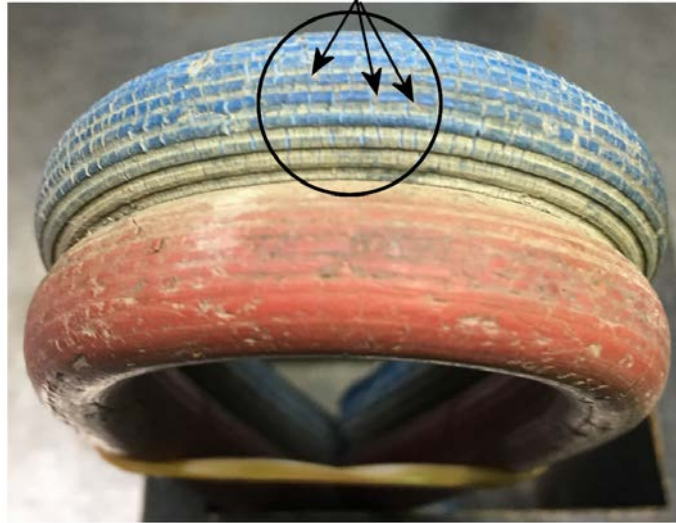
図 6.4 亀裂が見られるホースの例 この様な劣化したホースは使用しない。
