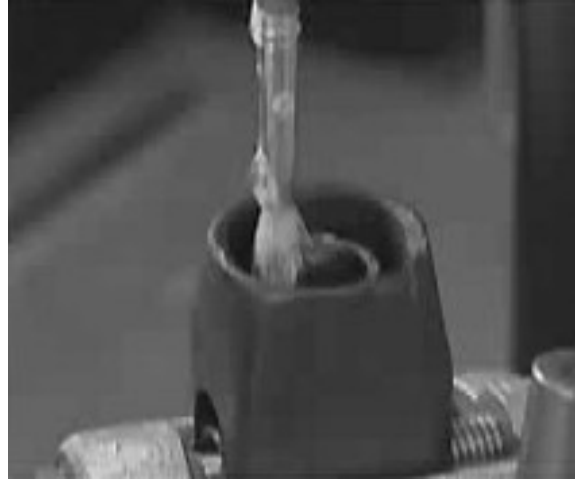
図 6.1 容器のガス漏れ点検 1) 漏れ検知液により、容器のバルブに気泡が発生しないか確認する。
