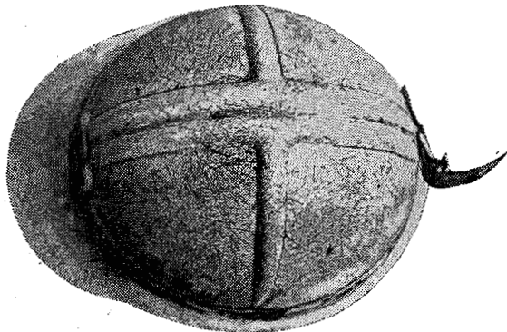
写真1 T金属鉱山で3年間使用したもの
