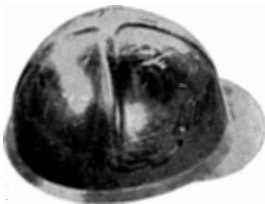
写真3 塗装のはく離したフェノール帽体
