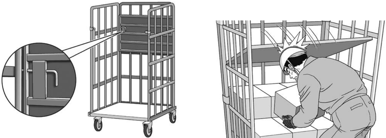
図 5-3 据付型中間棚および棚の落下による頭部受傷イメージ
