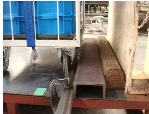
②背面側への転倒試験時 (キャスターの向き：平行)
