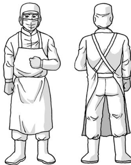
図 5-6 食品製造業（クリーンルーム内での業務等）の標準的な服装・装備の例
