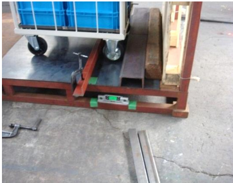
①左側への転倒試験時 (キャスターの向き：垂直)
