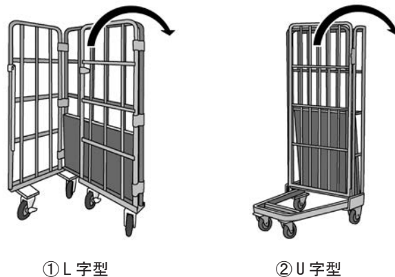
① L字型 ② U字型 図 6-8 折りたたんだ状態で転倒しやすい方向
