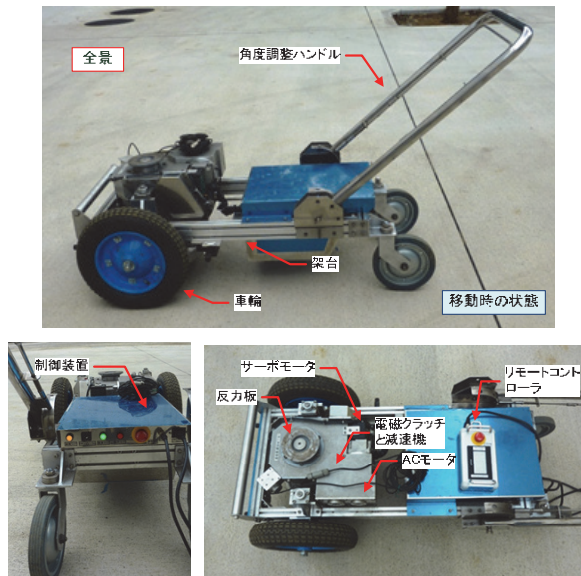
写真 4-2 現場地耐力試験 (BCT) 装置の外観 (2 号機)
