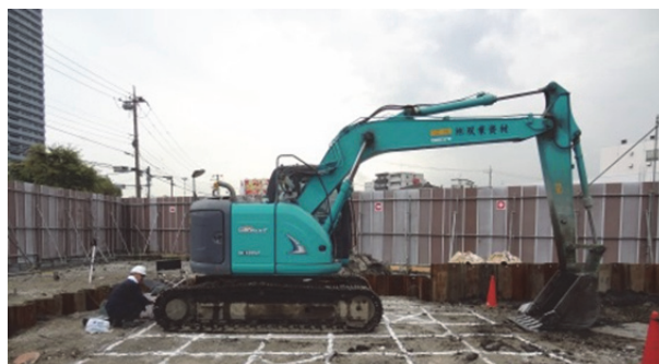
図 5-7 上部旋回体と下部走行体の向きを平行としバケットを接地させたドラグ・ショベル
