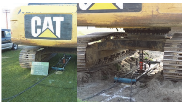
写真 4-19 GB_8(左側)とGB_9(右側)における PLT の様子
