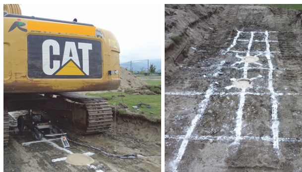
写真 4-18 GB_7 における支持力試験の様子(左)と載荷面に混在する礫の様子
