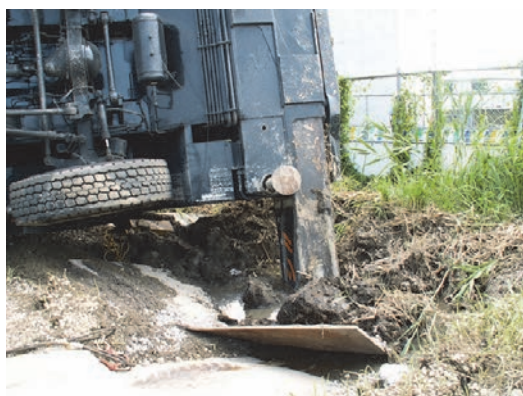
写真 2-2 機体右後方のアウトリガー沈下
