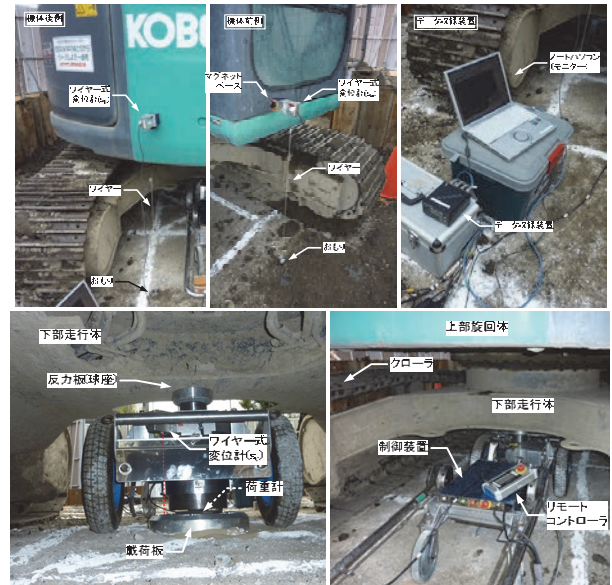
写真 4-8 地耐力試験における荷重と変位の計測
