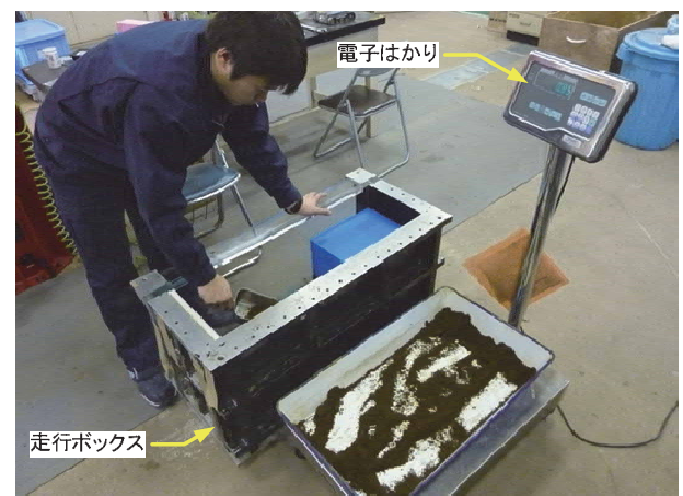
写真 5-3-3 分量を調整した関東ロームを投入する様子
