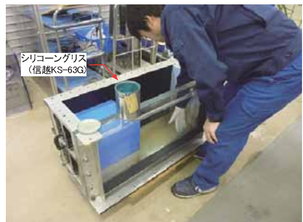
写真 5-3-2 走行ボックス内壁にグリスを塗布する様子
