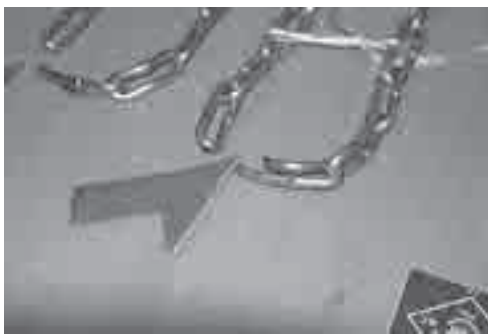
Fig.2B 実験体の破壊状況（ループ仕様、リンク差なし） （上端の鋼製丸棒との接触面で破断した場合の例）
