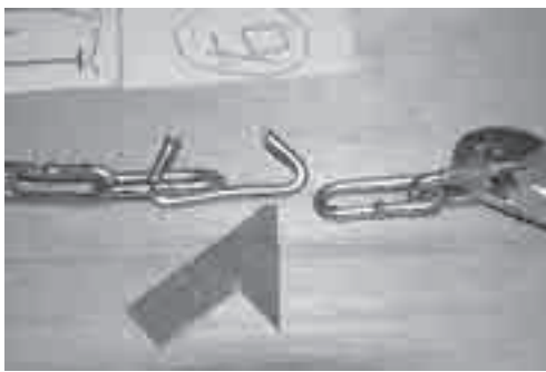
Fig.4B 実験体の破壊状況 (シングル仕様、1リンク差) (チェーン中央部で破断した場合の例)
