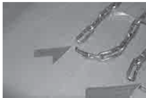
Fig.2B 実験体の破壊状況（ループ仕様、リンク差なし） （上端の鋼製丸棒との接触面で破断した場合の例）
