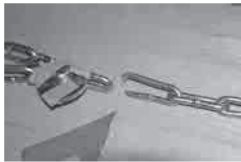
Fig.4B 実験体の破壊状況 (シングル仕様、1リンク差) (チェーン中央部で破断した場合の例)
