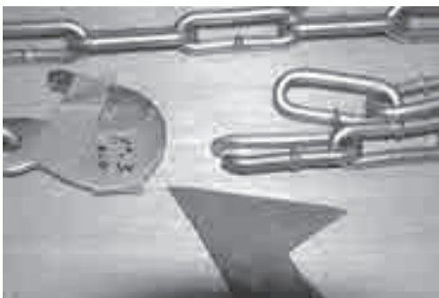
Fig.1B 実験体の破壊状況（ループ仕様、リンク差なし） （フックの箇所での破断した場合の例）
