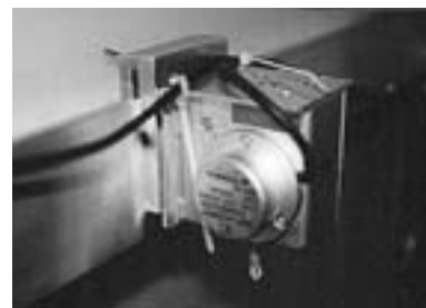
写真 5-3 ワイヤー式変位計 (共和電業DTP-D-500S)
