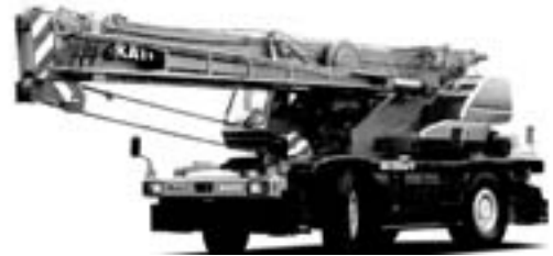
図1-7 ラフテレンクレーン
