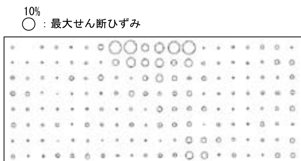
図 3-9 貫入量が0~5mm ( s/D=0\sim 0.05 ) における最大せん断ひずみの分布状況 (FT_6)
