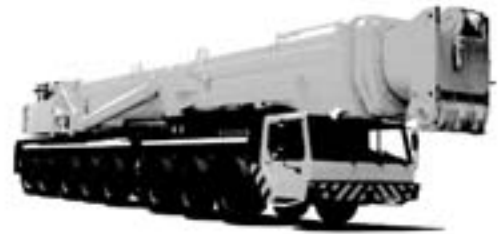
図1-6 オールテレンクレーン
