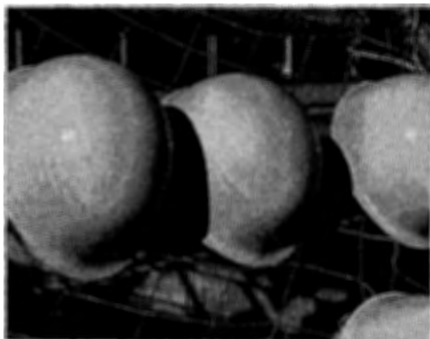
Photo 4 Change of appearance by exposure: ABS 暴露による外観の変化（試料 ABS）
