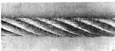
図 2 腐蝕1週間 衝撃試験用端部
