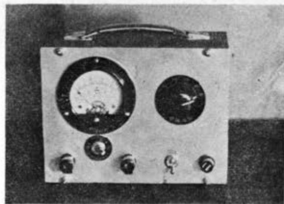
図-5 断続接地器の外観
