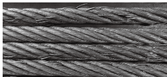
図 1 素線断線しているワイヤロープの表面
