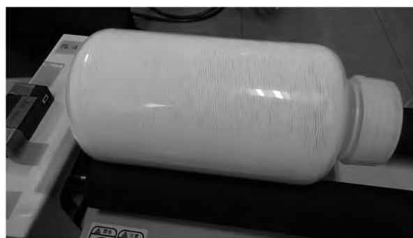
図4 アルミナ球(直径1 mm) 200 gを入れ、二酸化炭素ガスで封入したPFAボトルを攪拌している時の写真。
