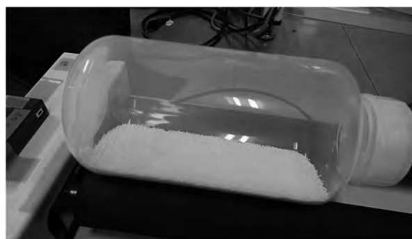
図3 アルミナ球(直径1 mm) 200 gを入れ、アルゴンガスで封入したPFAボトルを攪拌している時の写真。
