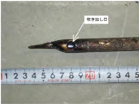
図 17 吹き出し用パイプ先端の様子
