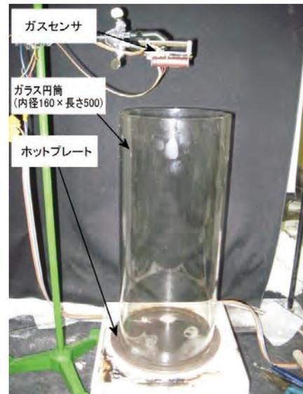
図 1 熱面実験装置の様子
