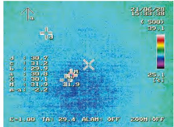
図11 RPF 堆積層上面の温度分布
