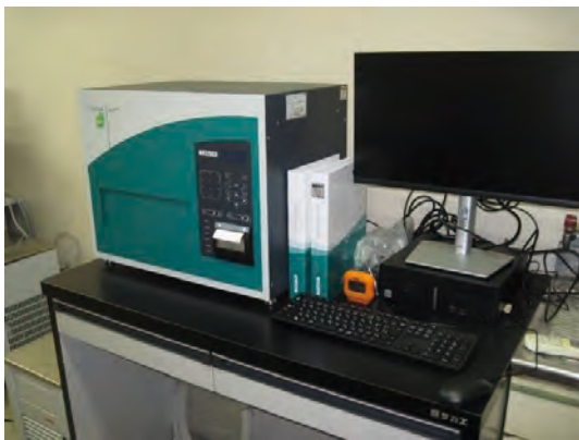
図 2 熱伝導率測定装置の外観
