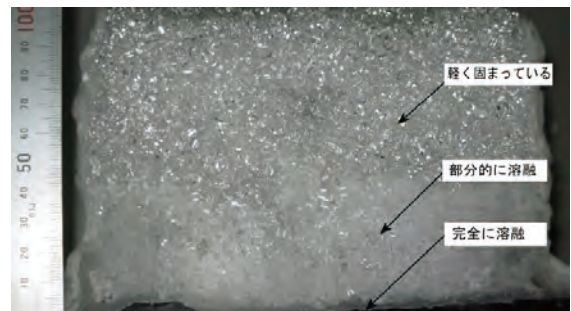
図 14 PMMA 原料樹脂ペレット堆積層の上方燃え拡がり途中で水消火後の堆積層断面の様子 14)
