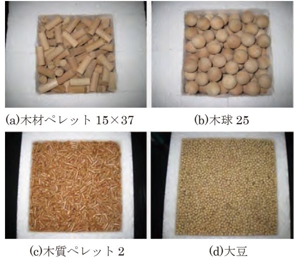
図 4 試料を型枠に充てんした様子
