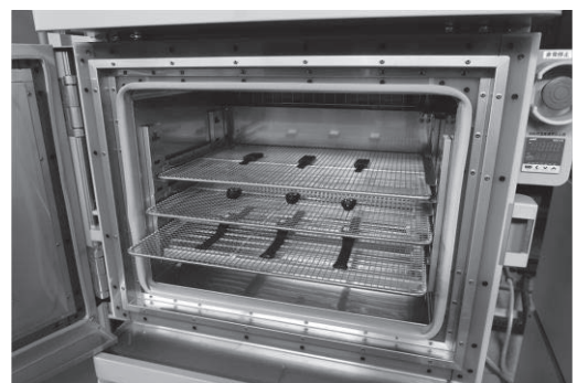
図 3-7 温湿度サイクル試験の様子
