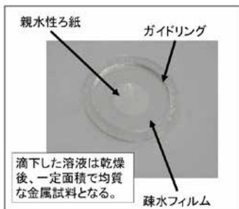
図 2 液体試料 X 線測定用点滴ろ紙
