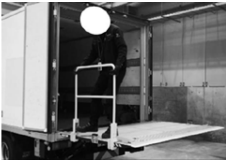
図2 着脱式の転落防止柵を装着する様子
