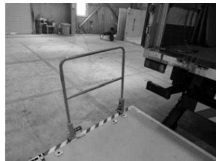
図3 昇降板用後付け柵
