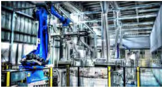
写真 2 洗浄前セット箇所から見た洗浄前搬送用ロボット（手前の青い物体）
