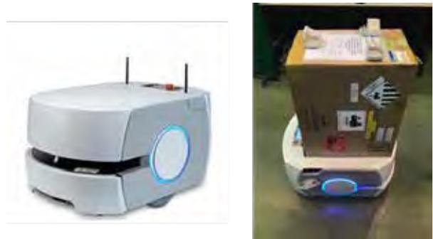
写真 5 トンネル内で使用する建設機械を想定したモバイルロボット。ロボット本体（左）及び搬送荷物上部にビーコンセンサを取り付けた後のロボット（右）
