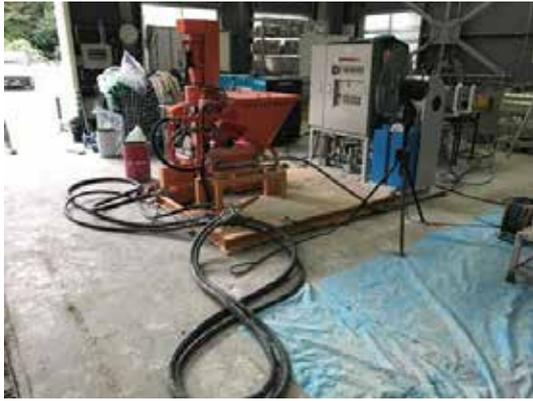
(a) 繊維補強モルタルの吹付け機
