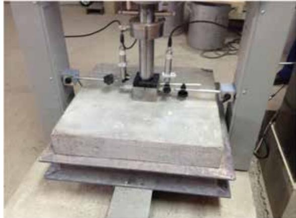
図4 EFNARCの押し抜き実験装置<sup>13)</sup>
