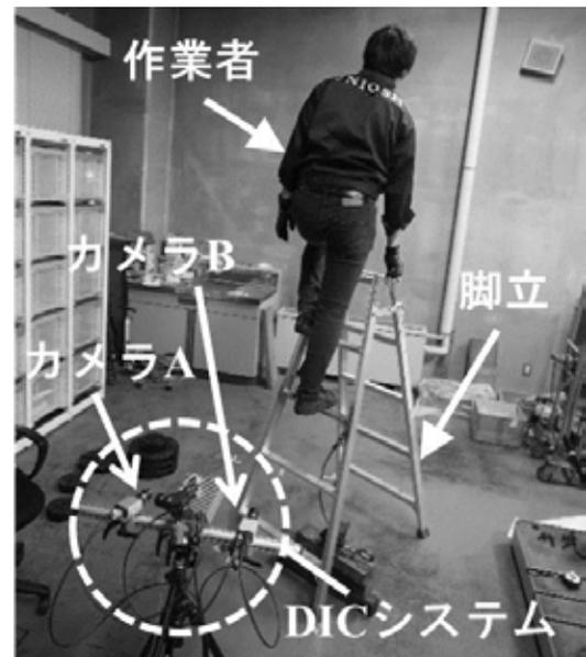
図 16 脚立使用時において発生する変位の測定
