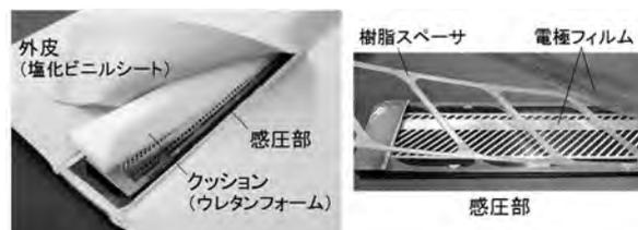
図6 試作した接触検知センサの構造
