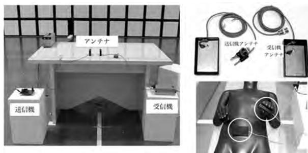
図 13 試作した人体通信装置
