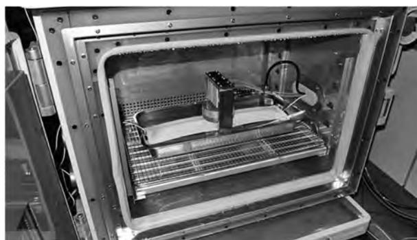
図 9 接触検知センサの高温耐久試験
