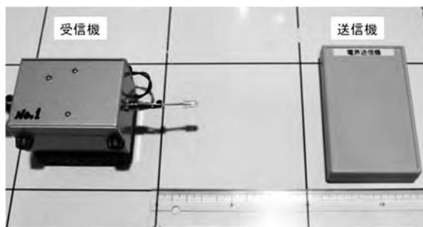
図 14 小型化した無線式接近検知センサ
