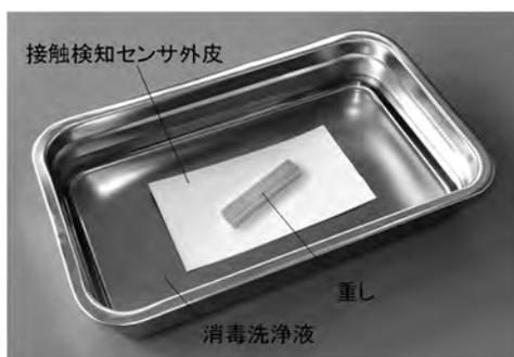
図 8 接触検知センサ外皮の耐薬品性試験
