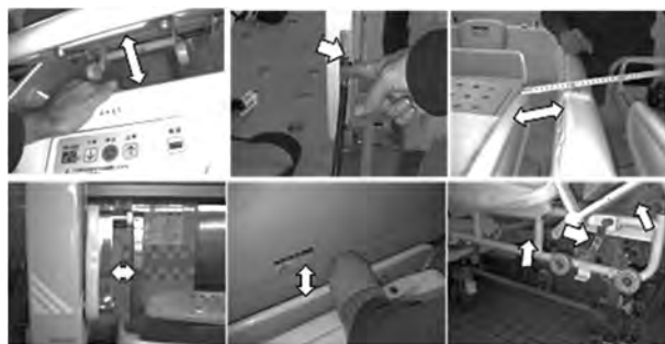
図 2 同定された機械的危険源（挟圧危険部）の例
