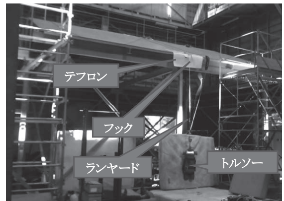
(d) ショックアブソーバあり, テフロンシートを設置した場合
