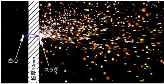
図7 切断板付近のスパッタの飛散状況 8)
