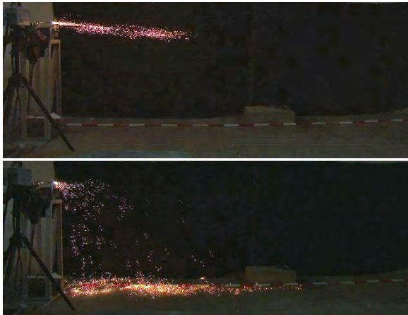
図5 スパッタの飛散状況，上：切断開始，下：切断中盤（床の水平の白赤スケールは 0.2 m ごと）
