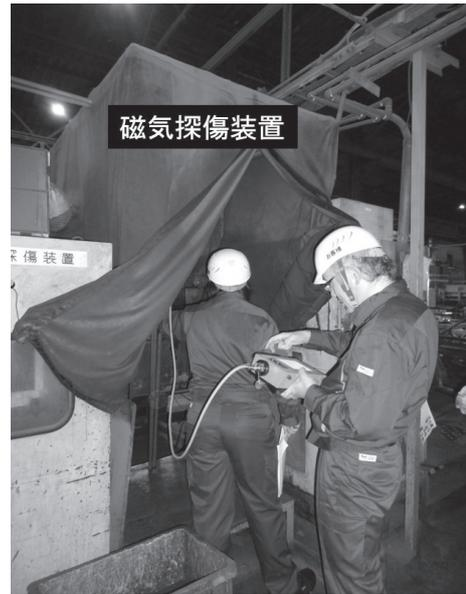
図8 磁気探傷装置より発生する磁界の測定の様子
