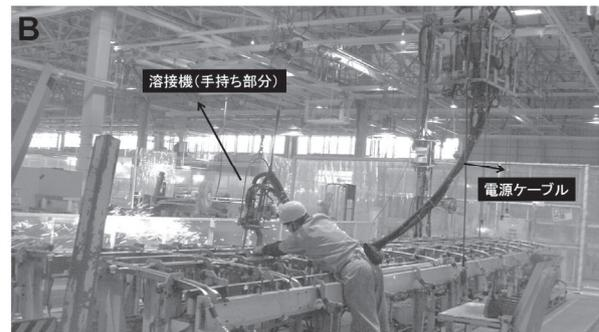
図4 手持ち式抵抗溶接装置より発生する磁界の測定 A: 測定ポイント, B: 作業の様子
