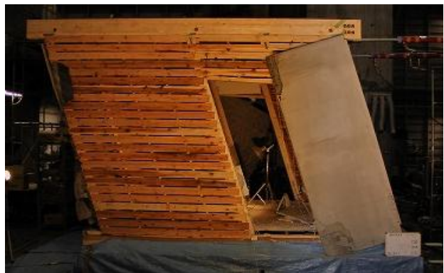
写真3 モルタル試験体の既変形状況 (R=1/5)
