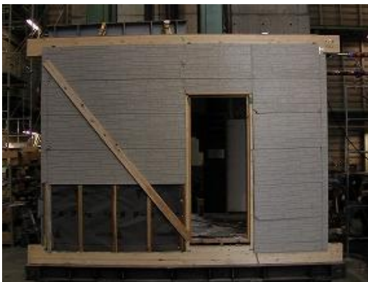
写真4 サイディング試験体
