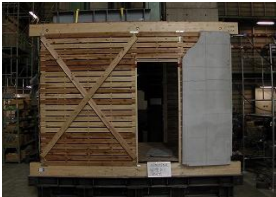
写真2 モルタル試験体
